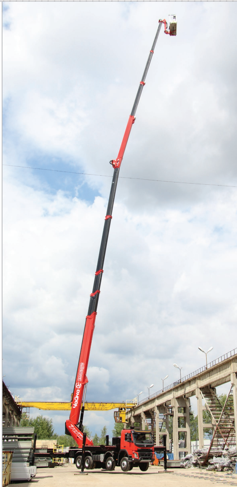
Автогидроподъемник телескопический с гуськом Чайка-SocageTJJ70 высотой 70 м на базе Volvo FM 460HP (8x4).
