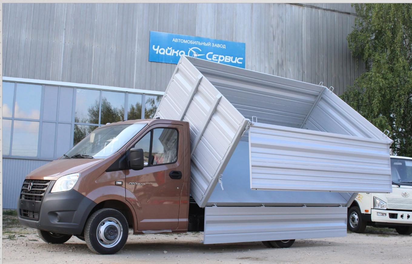
Самосвал с трехсторонней разгрузкой на базе ГАЗель NEXT, стальные борта Fuhmann. Масса перевозимого груза - 500 кг.
