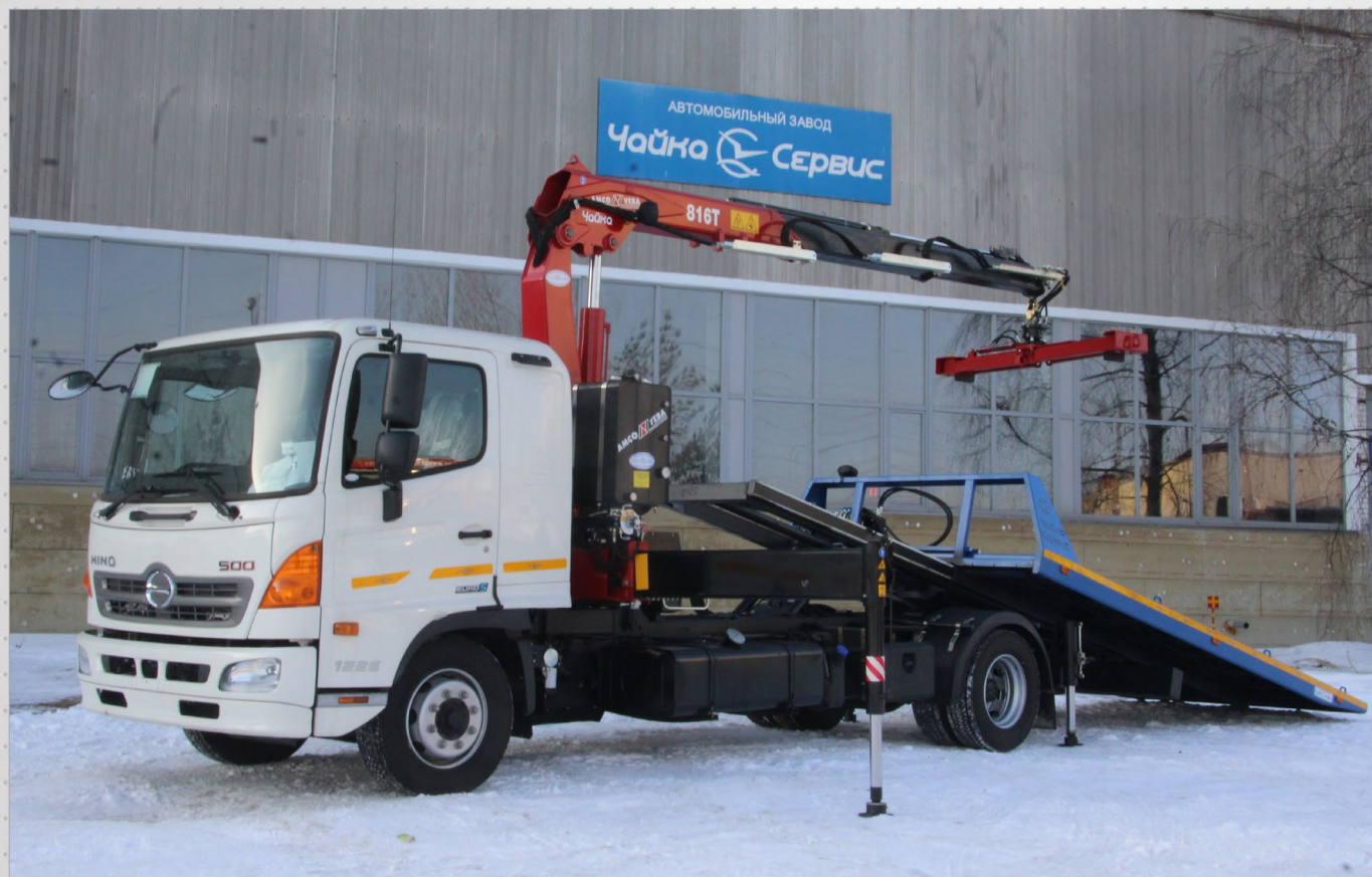
Эвакуатор со сдвижной платформой на базе HINO 500 с гидроманипулятором Amco-Veba 816. Грузоподъёмность платформы - до 5000 кг.
