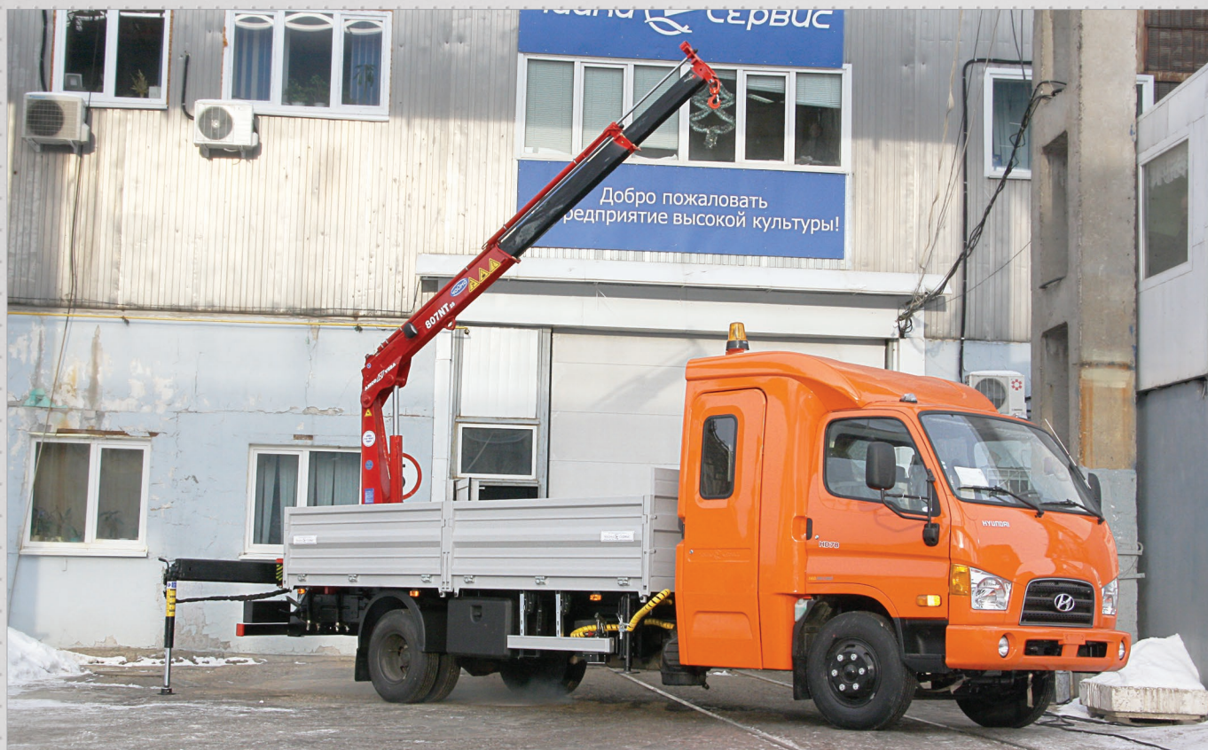
Hyundai HD78 с двухрядной кабиной «Чайка» с гидроманипулятором Чайка-Амсо Veba 807NT на заднем свесе. Макс. вылет – 5,15 м; г/п на макс. вылете – 1290 кг; грузовой момент – 6,73 т*м. Масса перевозимого груза – 2200 кг.
