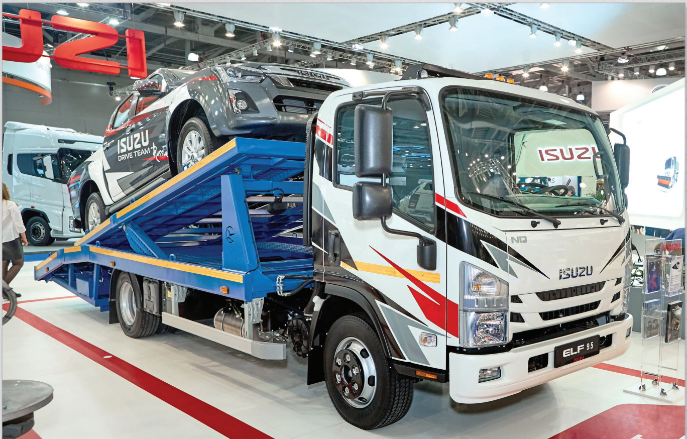
Двухэтажный эвакуатор с прицепом на базе ISUZU ELF 9.5 (NQR90). Грузоподъёмность нижней платформы (при незагруженной верхней) - 4500 кг ; верхней платформы - 1800 кг.
