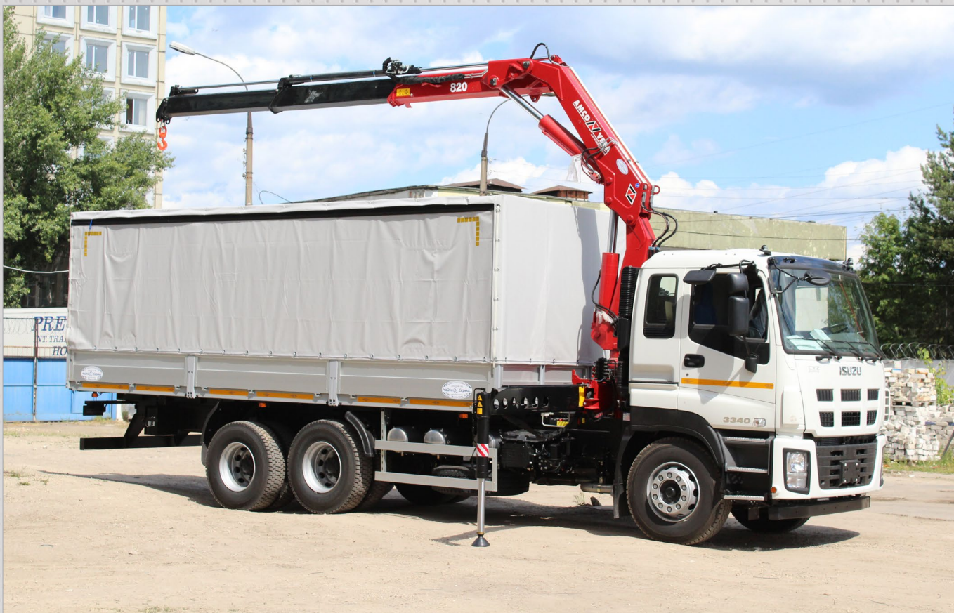
Isuzu CYZ с гидроманипулятором Чайка-Амсо Veba 820. Макс. вылет – 8.1 м; г/п на макс. вылете – 2300 кг; грузовой момент – 19.6 т*м. Масса перевозимого груза – 19295кг.
