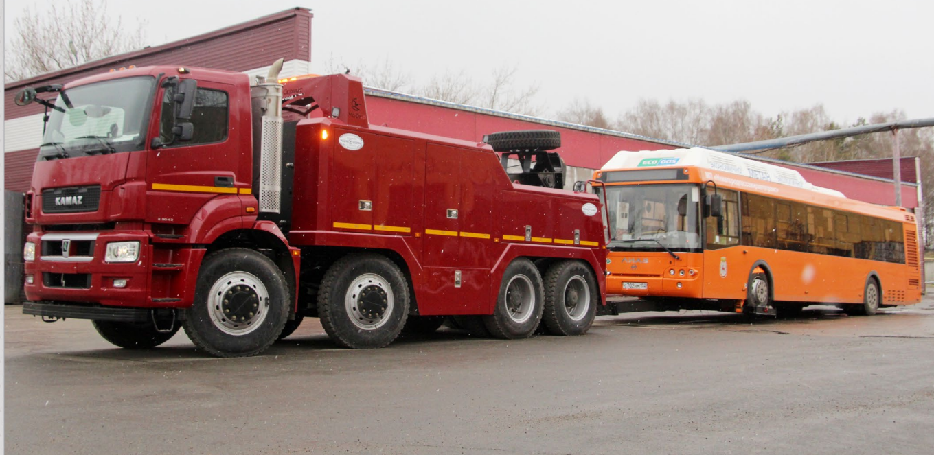
Эвакуатор с частичной погрузкой на базе КАМАЗ-65801 (К5042). Конструктивно допустимая грузоподъемность надстройки при буксировке - до 10 т.
