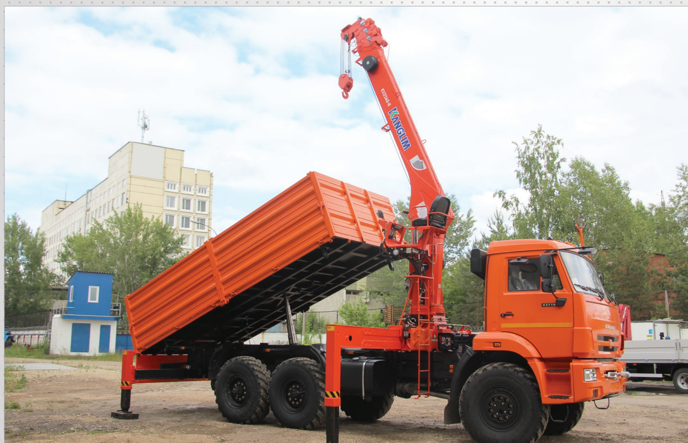
Самосвал с трехсторонней разгрузкой на базе КАМАЗ 43118 с КМУ Канглим, стальные борта Fuhrmann. Масса перевозимого груза - 7200 кг.
