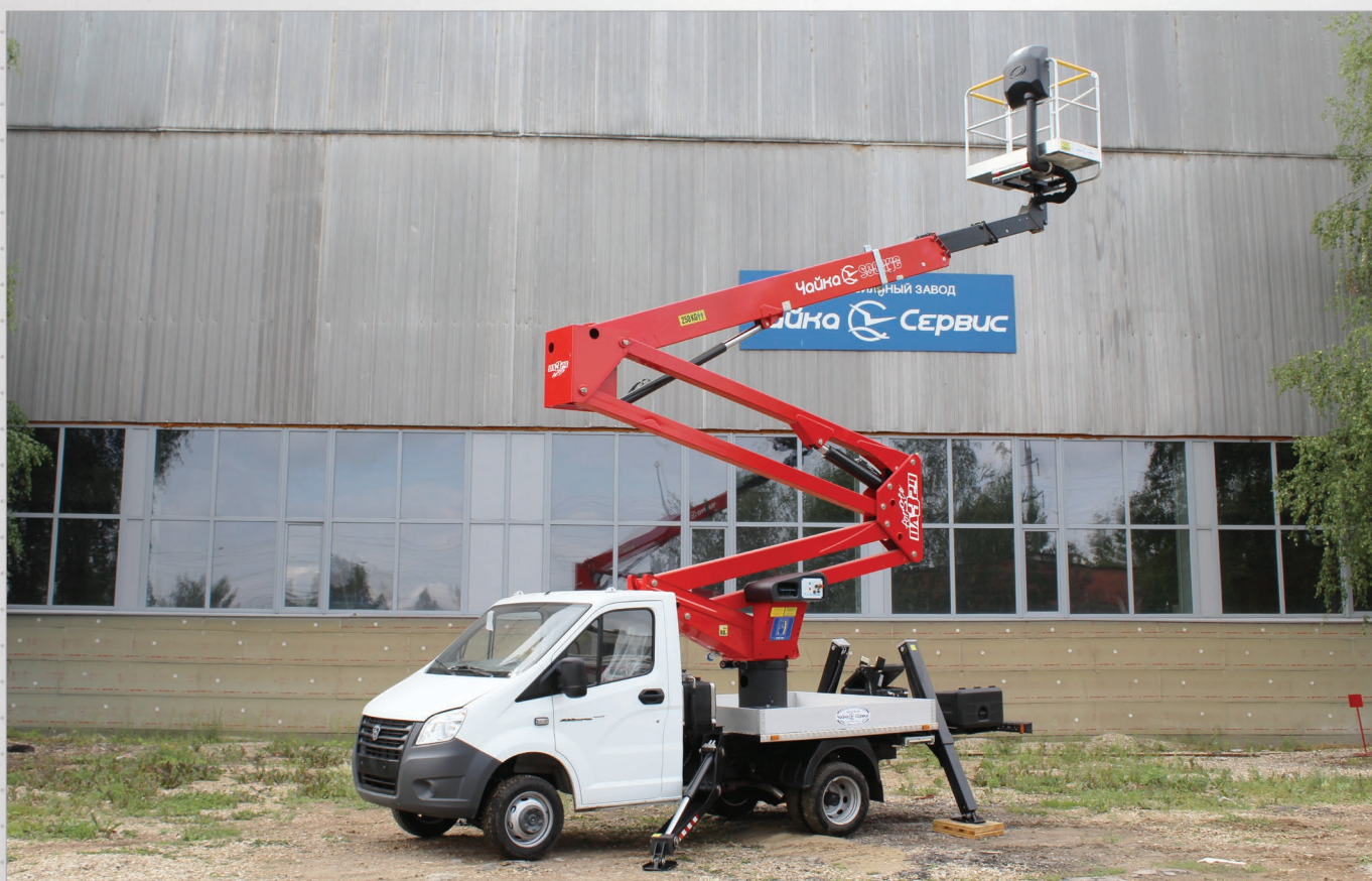
Автогидроподъемник комбинированный телескопический Чайка-Socage DA324 высотой 24 м на базе ГАЗель NEXT (возможна установка вышки высотой от 12 до 24 м).
