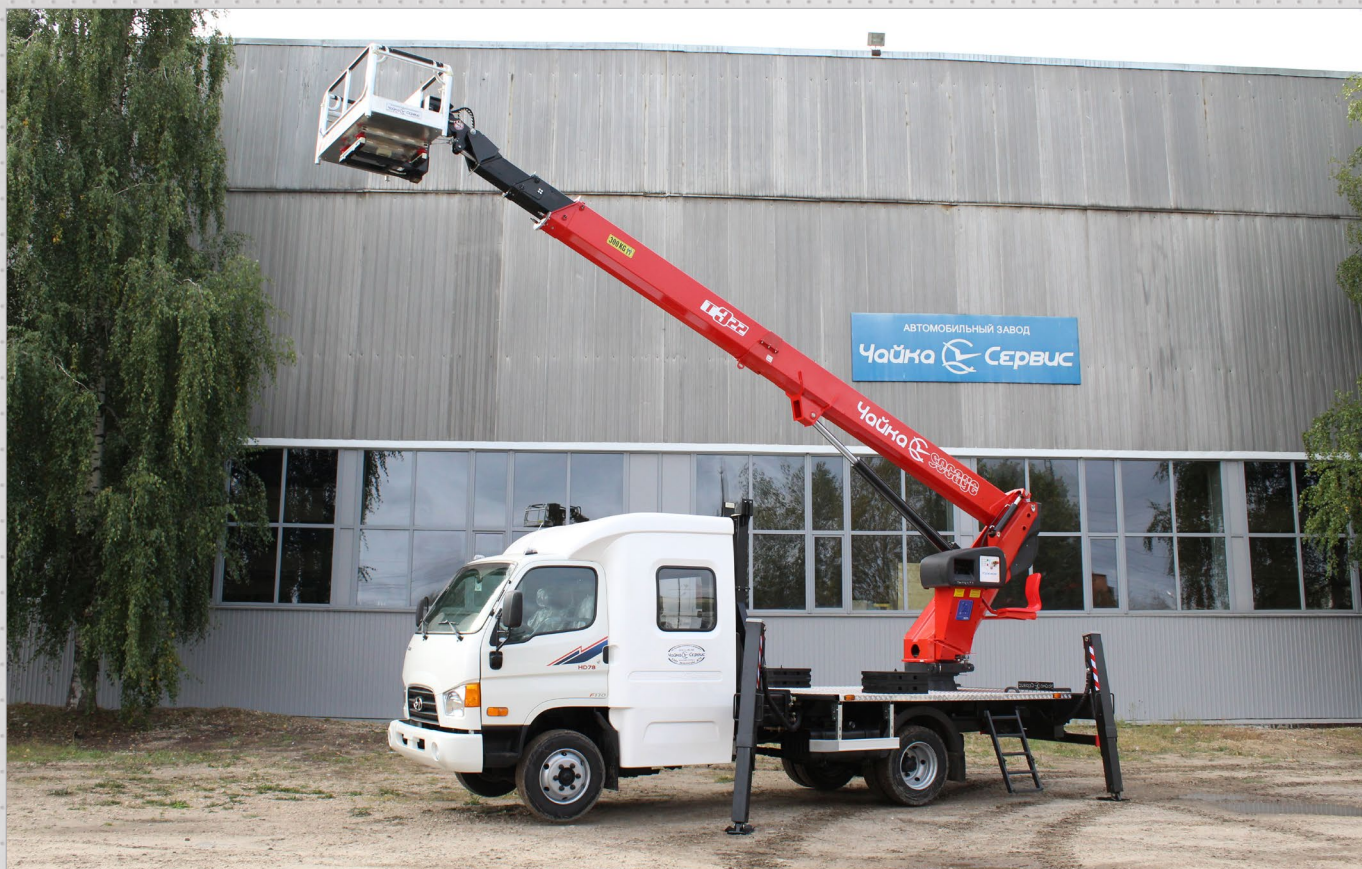
Автогидроподъемник телескопический Чайка-Socage T322 (высота подъема – 22 метра) на базе Hyundai HD-78 с двухрядной 7-местной кабиной «Чайка-7М».
