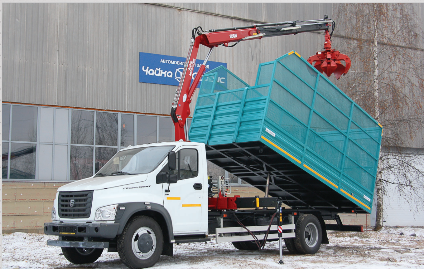
Самосвал с трехсторонней разгрузкой на базе ГАЗон NEXT с КМУ Чайка-Амсо Веба с грейфером, стальные борты Fuhrmann. Масса перевозимого груза - 3800 кг.
