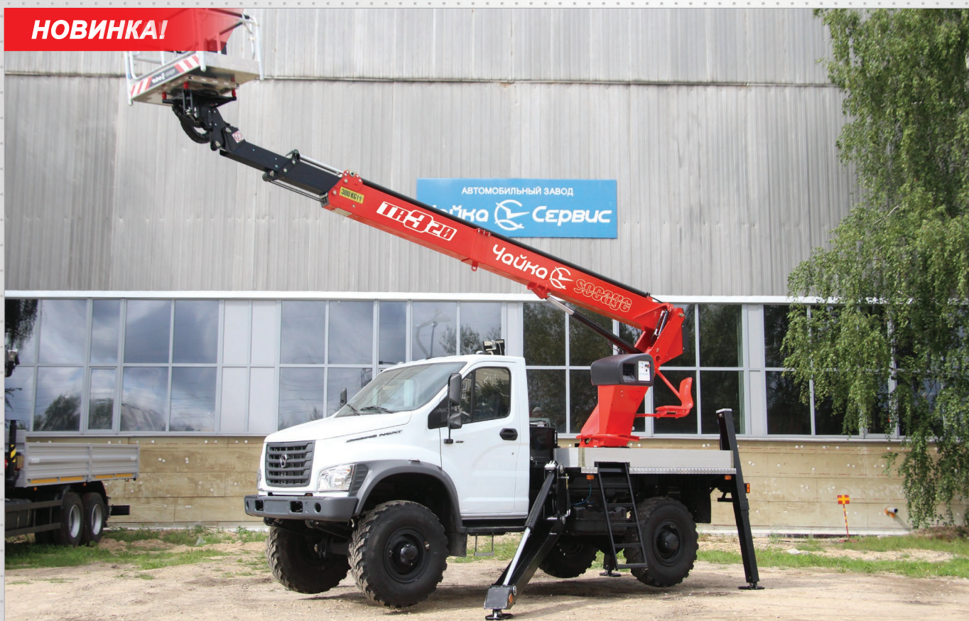
Автогидроподъёмник телескопический Чайка-Socage TR320 на базе шасси Sadko NEXT (макс. горизонтальный вылет - 13 м; г/п люльки - 300 кг).
