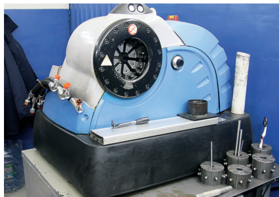
Оборудование для изготовления РВД
