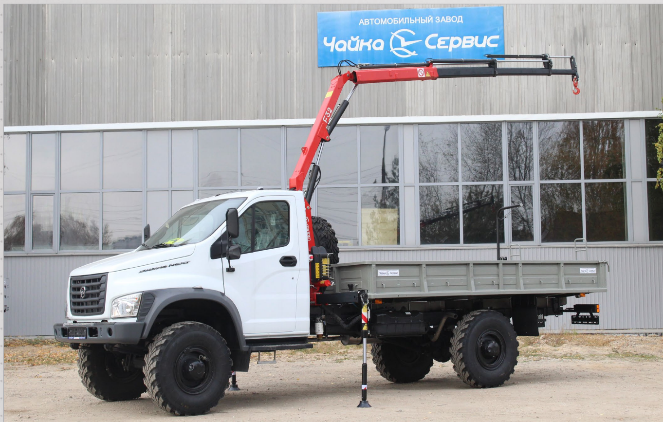
Садко NEXT с гидроманипулятором Чайка-Fassi F32. Макс. вылет – 6,8 м; г/п на макс. вылете – 300 кг; грузовой момент – 2,65 т*м. Масса перевозимого груза – 1985 кг.
