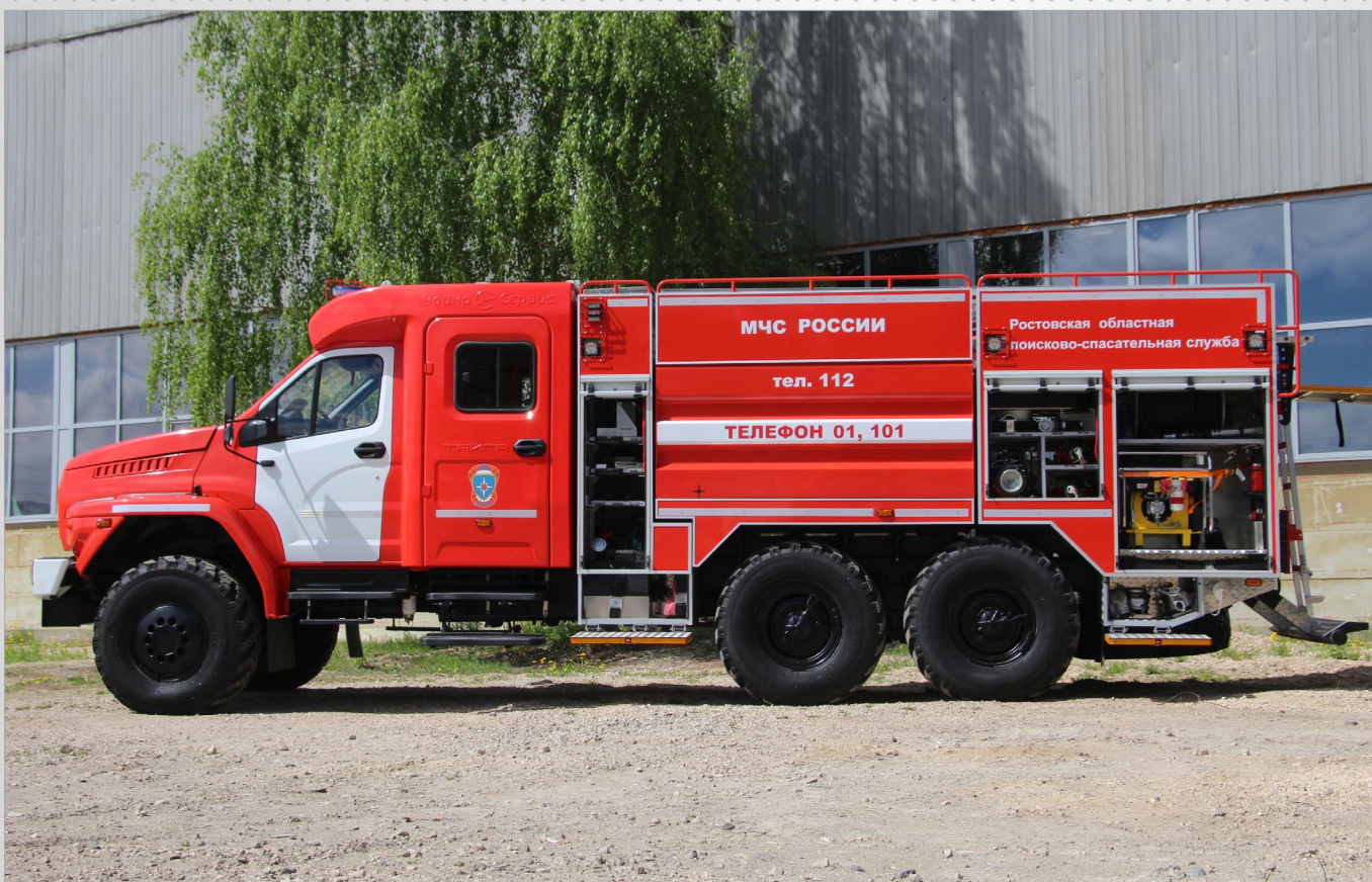
Автомобиль пожарно-спасательный Урал Next (6x6) АПС-6,0-40/4 «Тайга» с двухрядной 7-местной кабиной. Запас огнетушащих средств: вода - 6 м 3 ; пенообразователь - 360 л.
