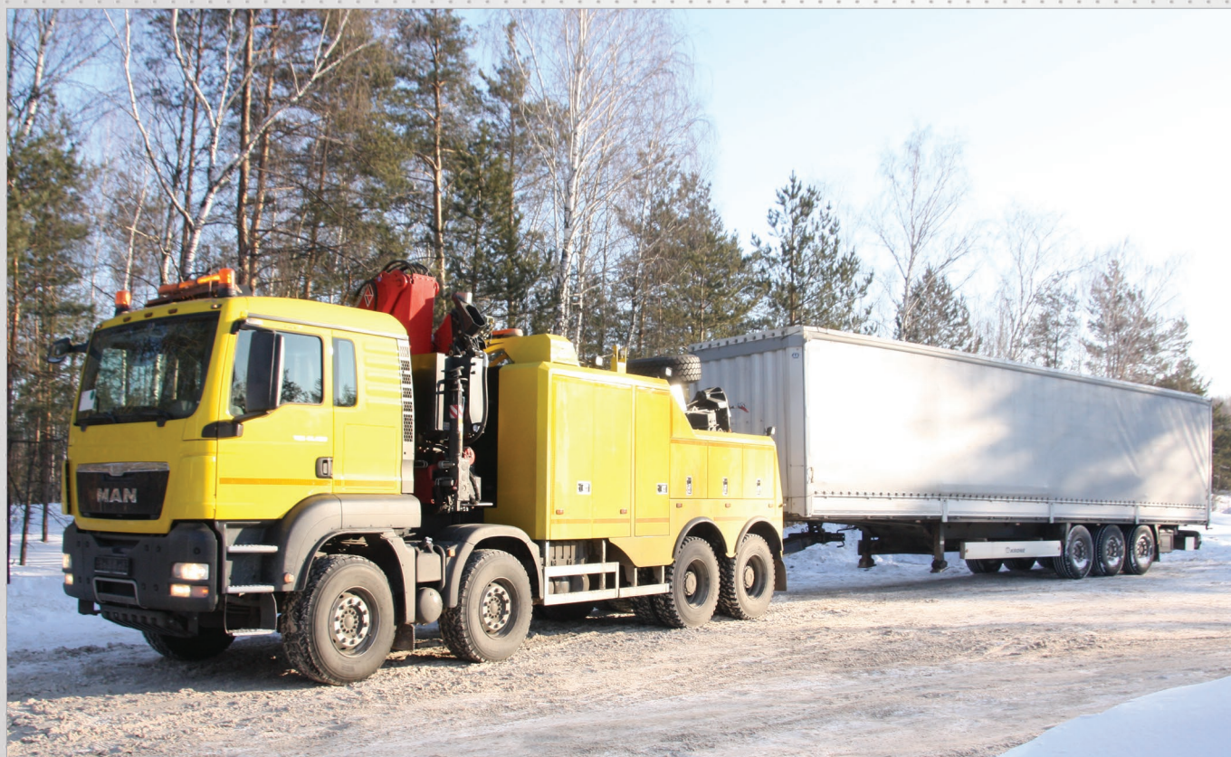
Эвакуатор с частичной погрузкой на базе MAN TGS 41.480 (8x4). Грузоподъемность эвакуатора в стационарном положении с использованием задних опор (на полезном вылете 1525 мм) - 12 т, при буксировке - 9 т.
