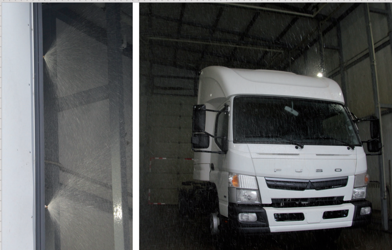
Дождевальная камера для испытания двухрядных и спальных кабин.
