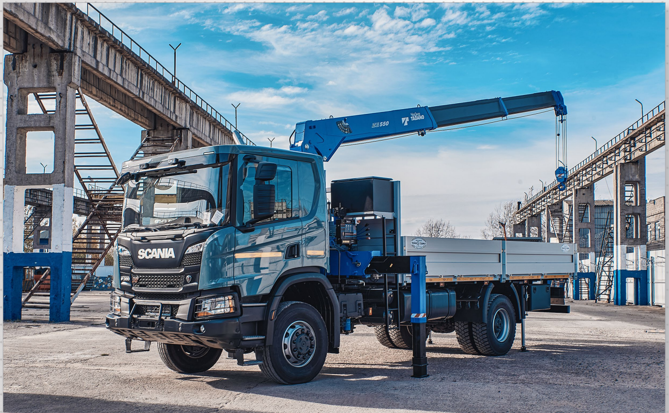
SCANIA P380 с гидроманипулятором Чайка-Tadano TM-ZE554 и алюминиевой бортовой платформой. Макс. вылет – 10,58 м; г/п на минимальном радиусе (2,5 м) – 5000 кг; грузовой момент – 12,5 т*м. Масса перевозимого груза – 7210 кг.
