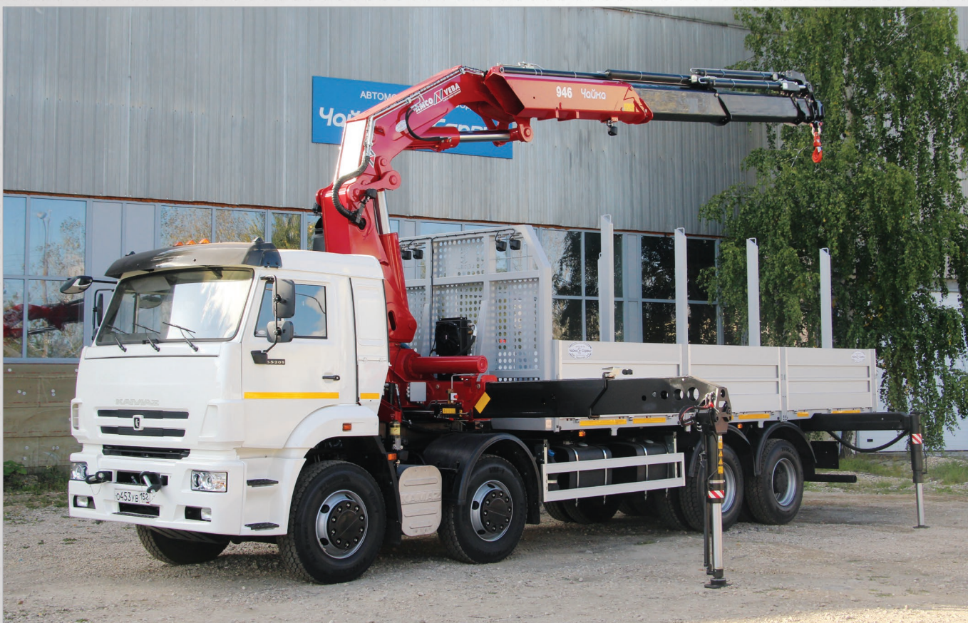
КАМАЗ-65201 с гидроманипулятором Чайка-Амсо Veba 946. Макс. вылет – 12 м; г/п на макс. вылете – 3220 кг; грузовой момент – 43,4 т*м. Масса перевозимого груза – 19910 кг.
