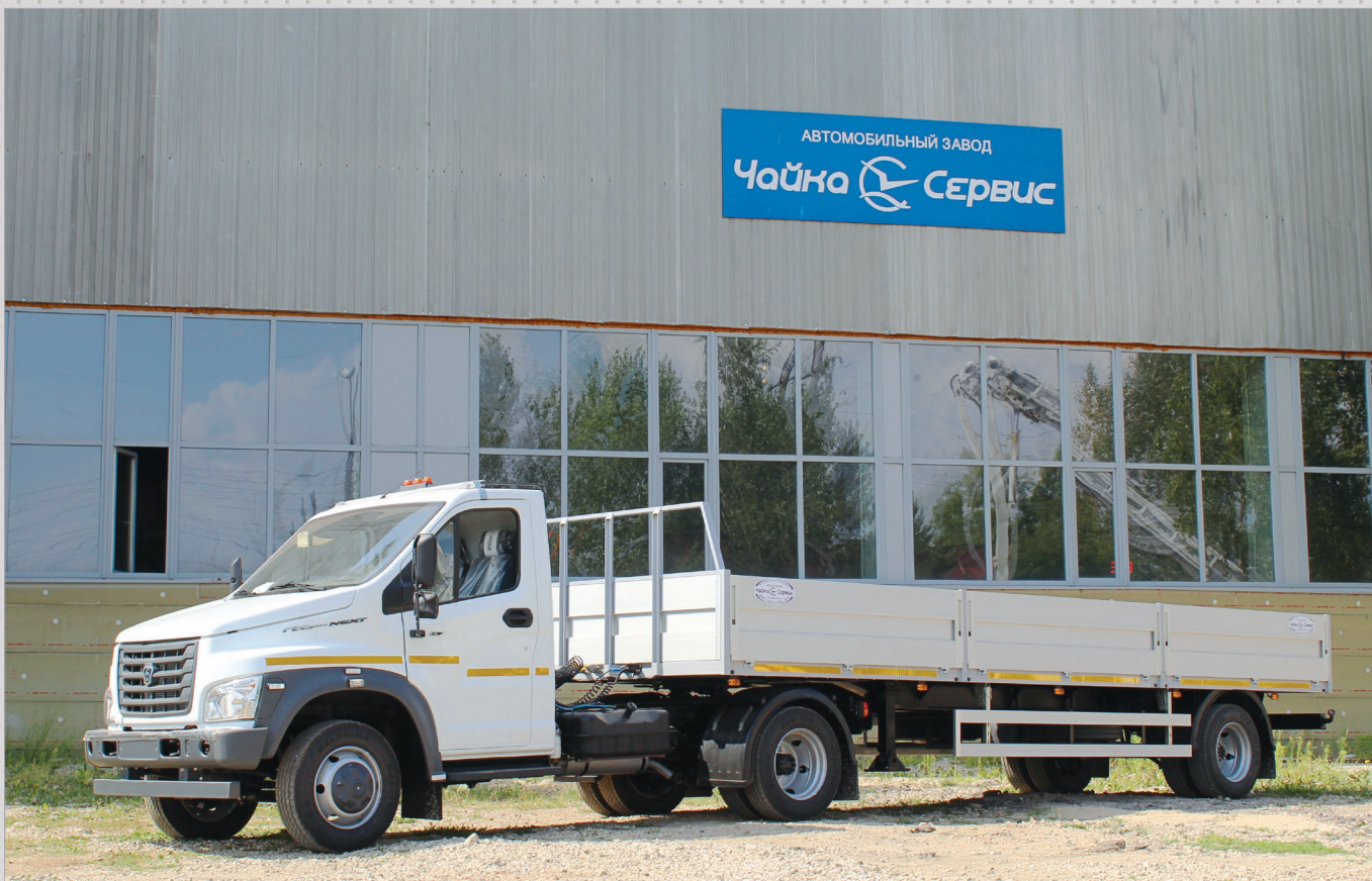
Седельный тягач с полуприцеп на базе ГАЗон NEXT (возможно со спальным кабиной). Длина полуприцепа 7,5, 11 м или 12,2 м.
