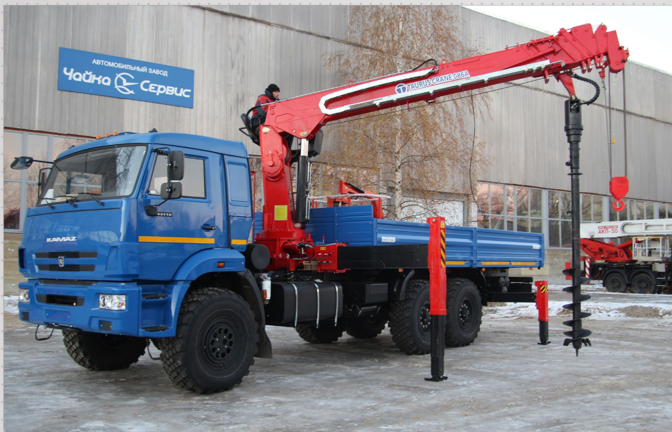
КАМАЗ-43118 с БКУ Taurus 086 с люлькой и буром. (АЗ «Чайка-Сервис» также производит монтаж КМУ любых других производителей в случае если они предоставляются заказчиком).
