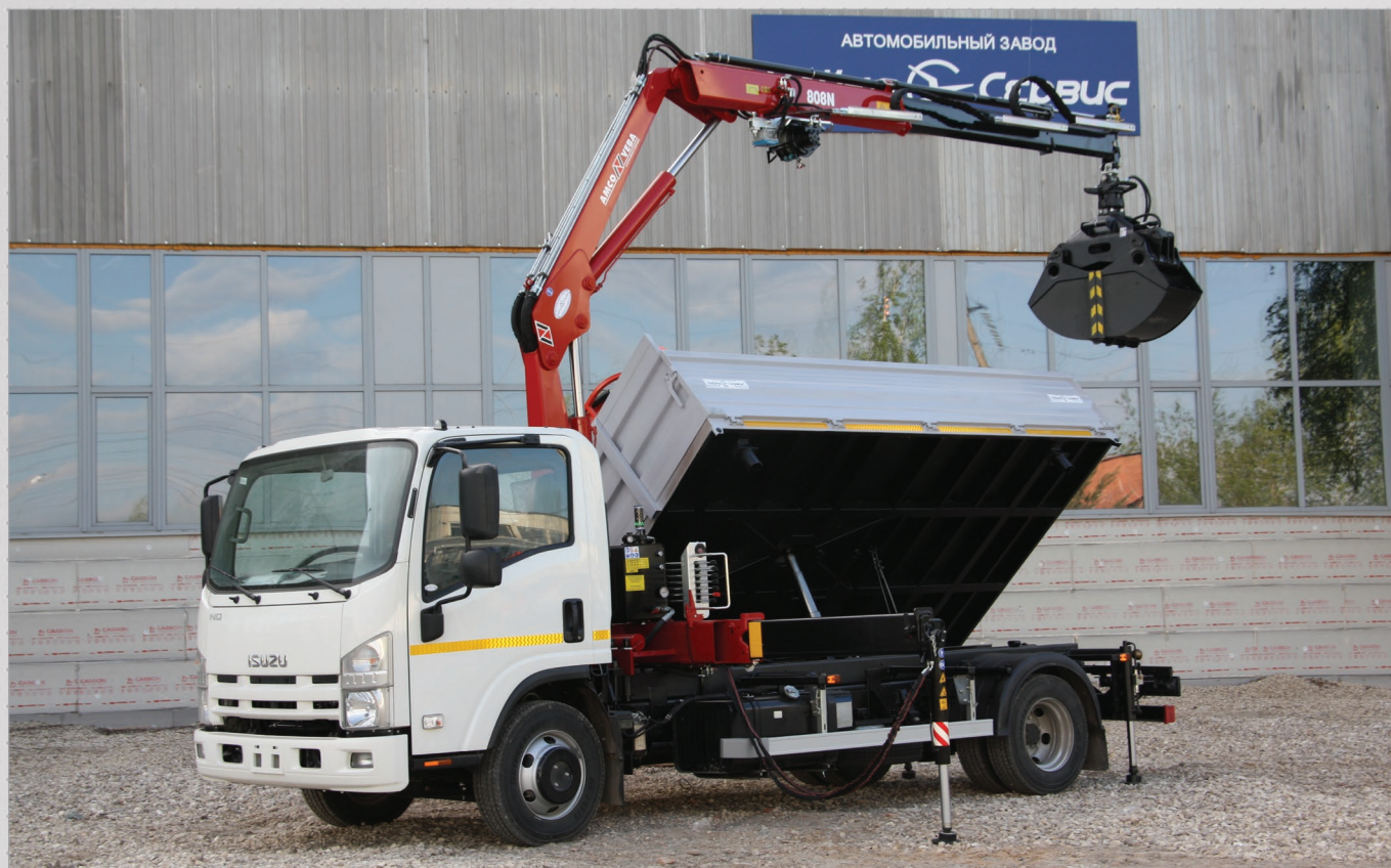
Самосвал с трехсторонней разгрузкой на базе ISUZU NQR-90 Гидроманипулятор Чайка-Атсо Веба с лебедкой и грейфером, стальные борта Fuhrmann. Масса перевозимого груза - 3800 кг.
