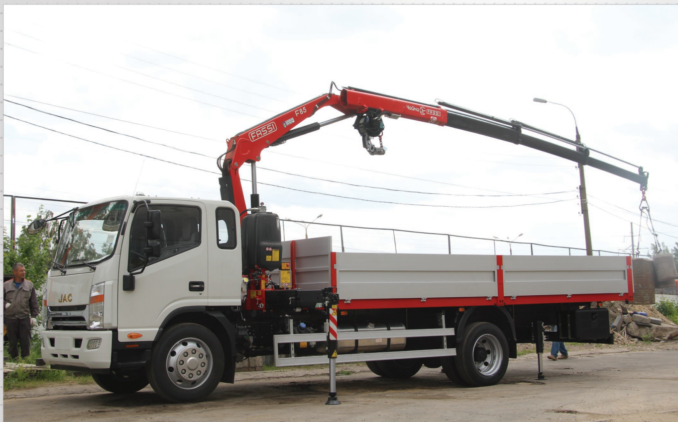
JAC N120 с гидроманипулятором Чайка-Fassi F85.B023 с лебедкой. Макс. вылет – 9,4 м; г/п на макс. вылете – 725 кг; грузовой момент – 7,95 т*м. Грузоподъемность лебедки КМУ – 1800 кг. Масса перевозимого груза – 4985 кг.
