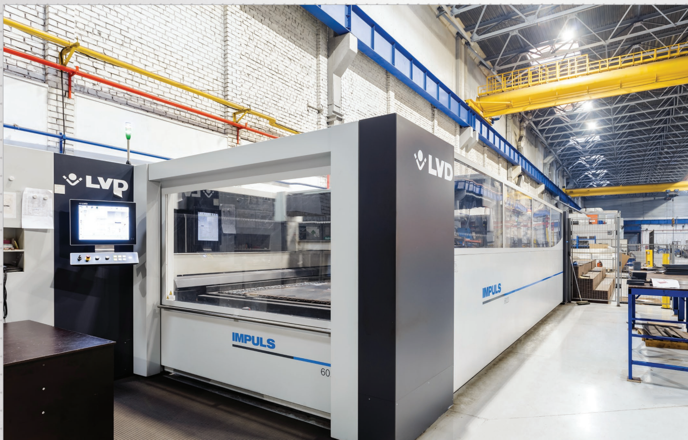
Лазерный комплекс LVD Impuls 6020 4KW (Размер листа 6250x2050 мм). Произведена реконструкция производственной площади.
