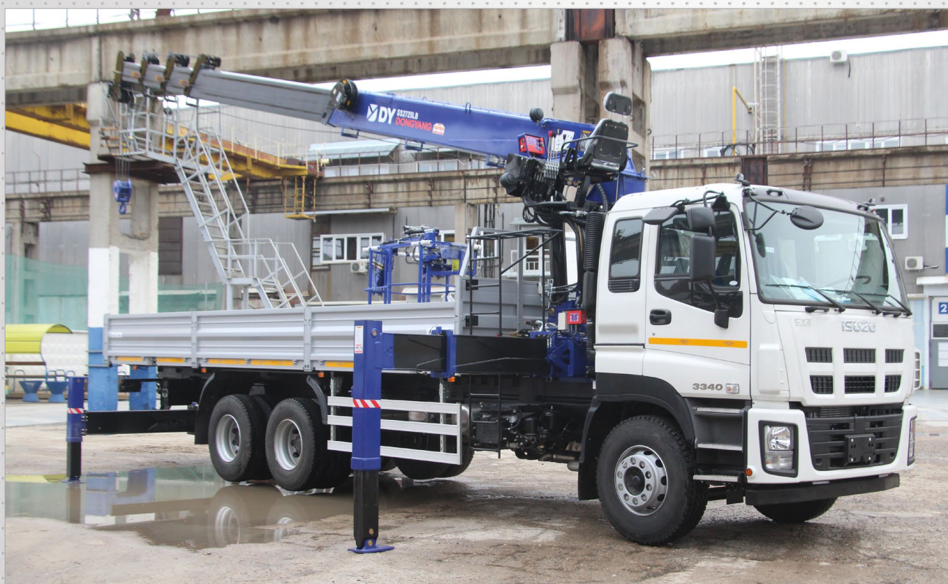
ISUZU CYZ52 с МФК (многофункциональный кран) Dong Yang SS2725LB. Макс. вылет – 20,2 м; г/п на макс. вылете – 12000 кг; грузовой момент – 29 т*м. Масса перевозимого груза – 14740кг.
