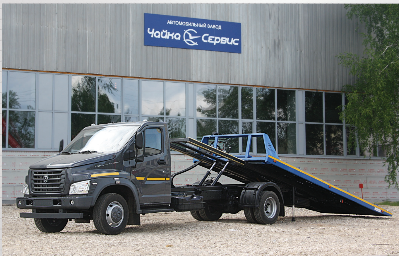
Эвакуатор со сдвижной платформой на базе ГАЗон NEXT city Грузоподъемность платформы - 3500 кг.
