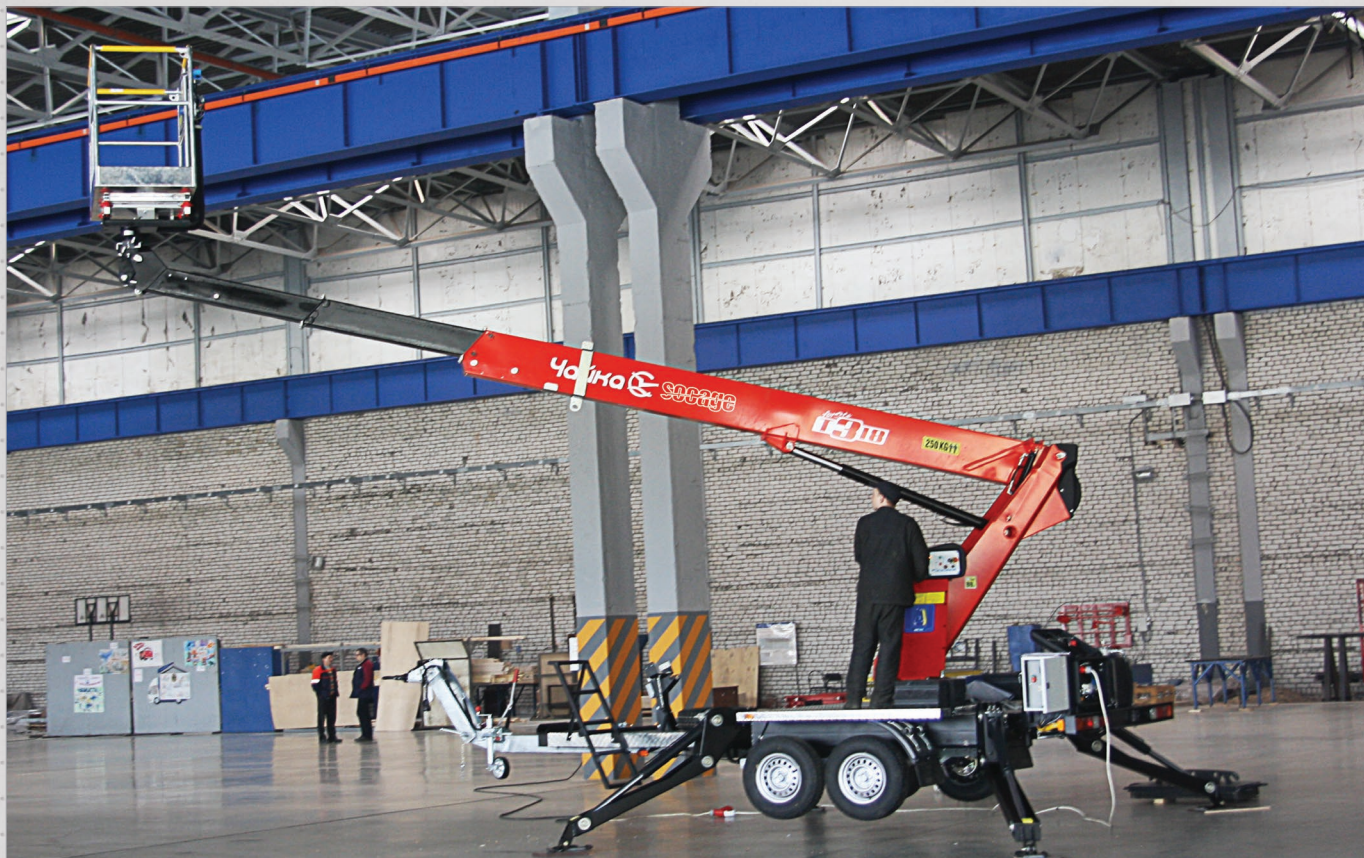
Прицепной телескопический подъёмник Чайка-Socage Т318 с высотой 18 м. Возможна установка вышки высотой от 12 до 24 м. Прицепной подъёмник работает либо от подключения к электрической сети 220 или 380 вольт, либо от бензиновой или дизельной гидростанции.
