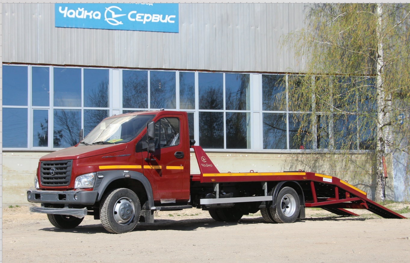
Эвакуатор с ломаной платформой на базе ГАЗон NEXT. Грузоподъемность платформы - 4250 кг.
