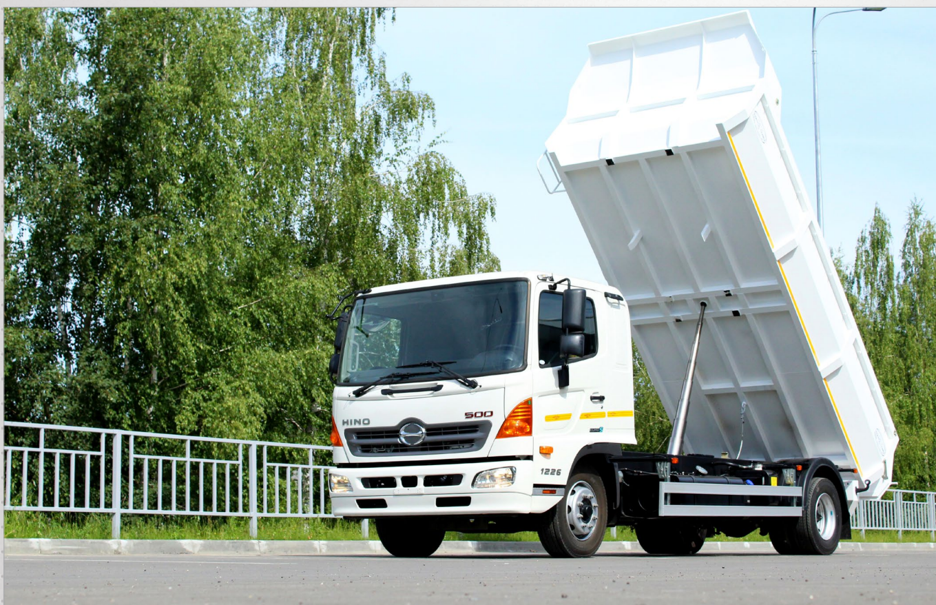
Самосвал «совок» на базе HINO-500GD. Масса перевозимого груза - 5650 кг. Объем платформы - 9,6м 3
