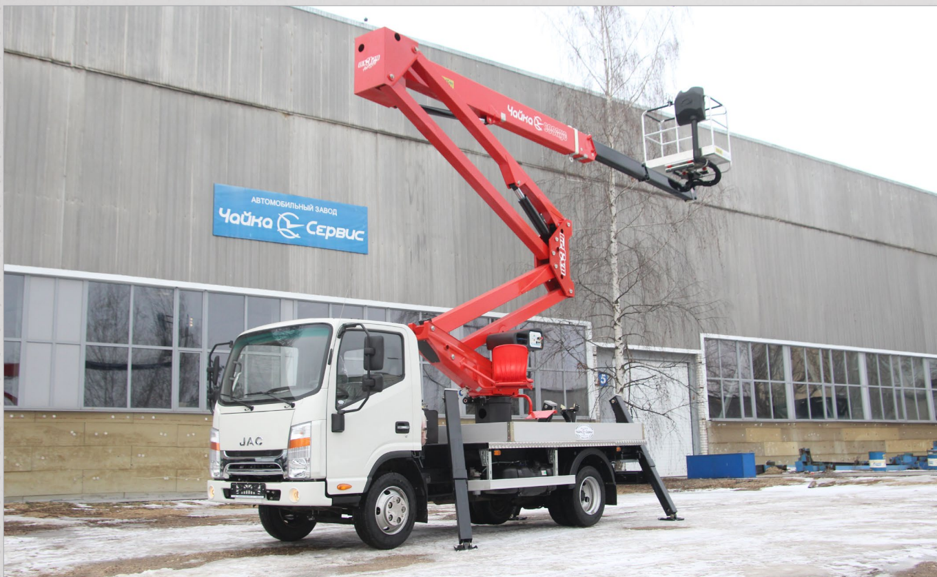
Автогидроподъёмник комбинированный телескопический Чайка-Socage DA324 (высота подъёма – 24 метра) на базе JAC.
