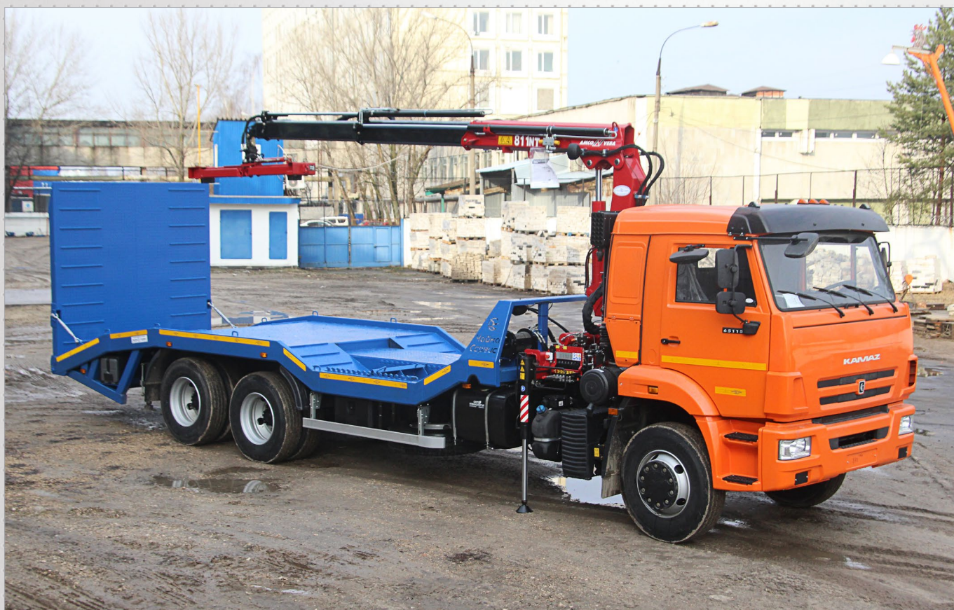
Эвакуатор с ломаной платформой и гидроаппарелью, гидроманипулятором Чайка-Амсо Veba 811NT 2S. Грузоподъемность платформы - 11550 кг.
