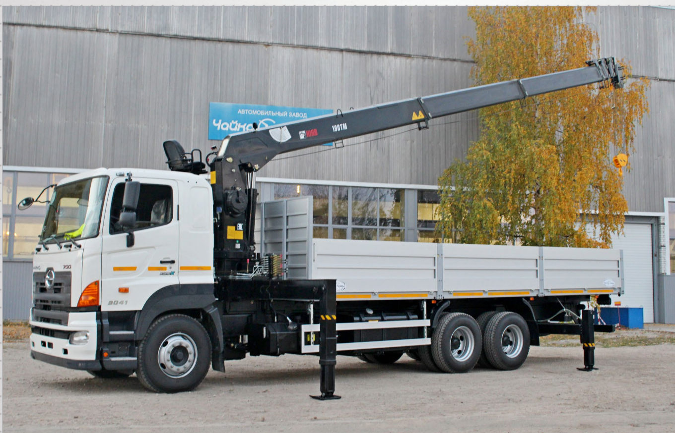
HINO 700 с гидроманипулятором HIAV 190 TM-6. Макс. вылет – 19,5 м; г/п на макс. вылете – 8000 кг; грузовой момент – 18,1 т*м. Масса перевозимого груза – 17195 кг.
