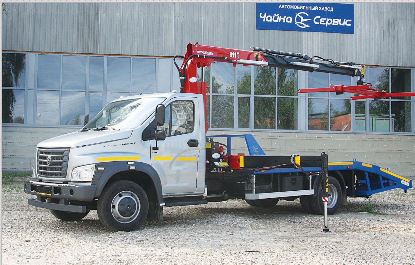
Эвакуатор с ломаной платформой и гидроманипулятором Чайка-Amco Veba 811T 2s на базе ГАЗон NEXT. Возможна установка крана с грузовым моментом от 7 до 10,3 т*м.
