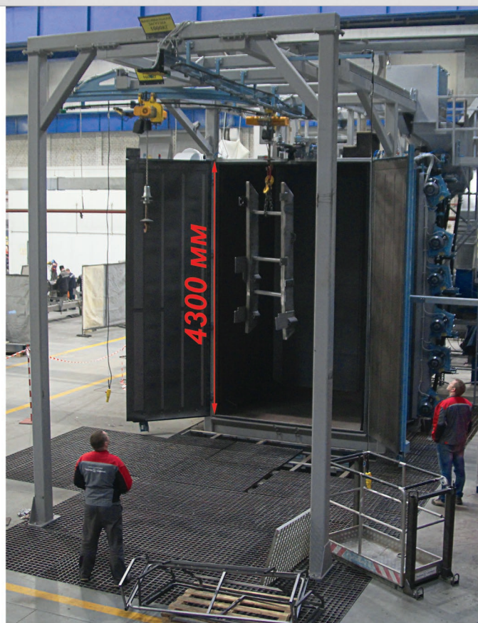
Дробеметные камеры высотой 2 и 4,3 метра.
