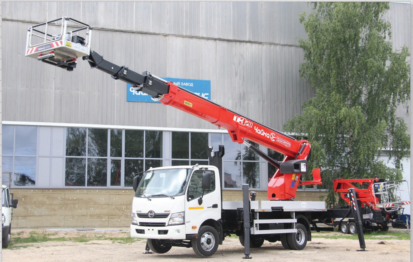
Автогидроподъёмник телескопический Чайка-Sosage T328 с расположением над кабиной (высота подъёма – 18 м) на базе HINO 300.
