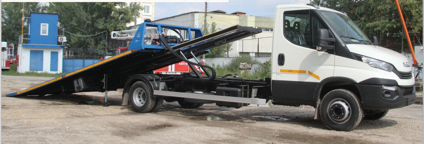
Эвакуатор со сдвижной платформой без отбортовки на базе Iveco Daily. Грузоподъёмность платформы - 2650 кг.
