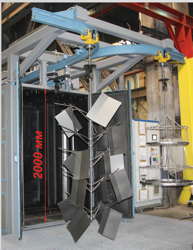
Дробеметные камеры высотой 2 и 4,3 метра.
