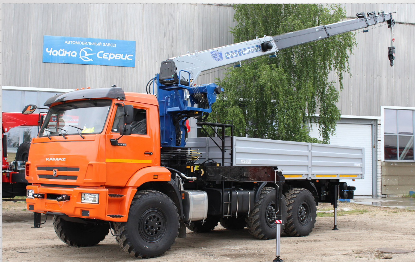
КАМАЗ-43118 с гидроманипулятором Чайка-Галичанин. Макс. вылет – 19 м; г/п на макс. вылете – 7000 кг; грузовой момент – 15 т*м. Масса перевозимого груза – 7060 кг.
