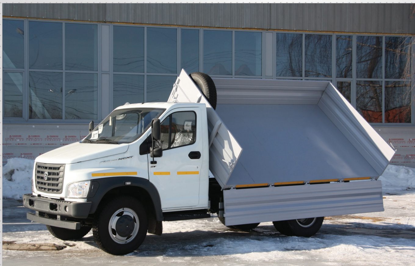
Самосвал с трехсторонней разгрузкой на базе ГАЗон NEXT, стальные борта Fuhmann. Масса перевозимого груза - 4370 кг.
