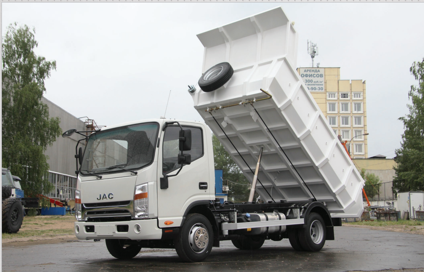
Самосвал «совок» на базе JAC N80. Масса перевозимого груза - 3500 кг. Объем платформы - 6м 3
