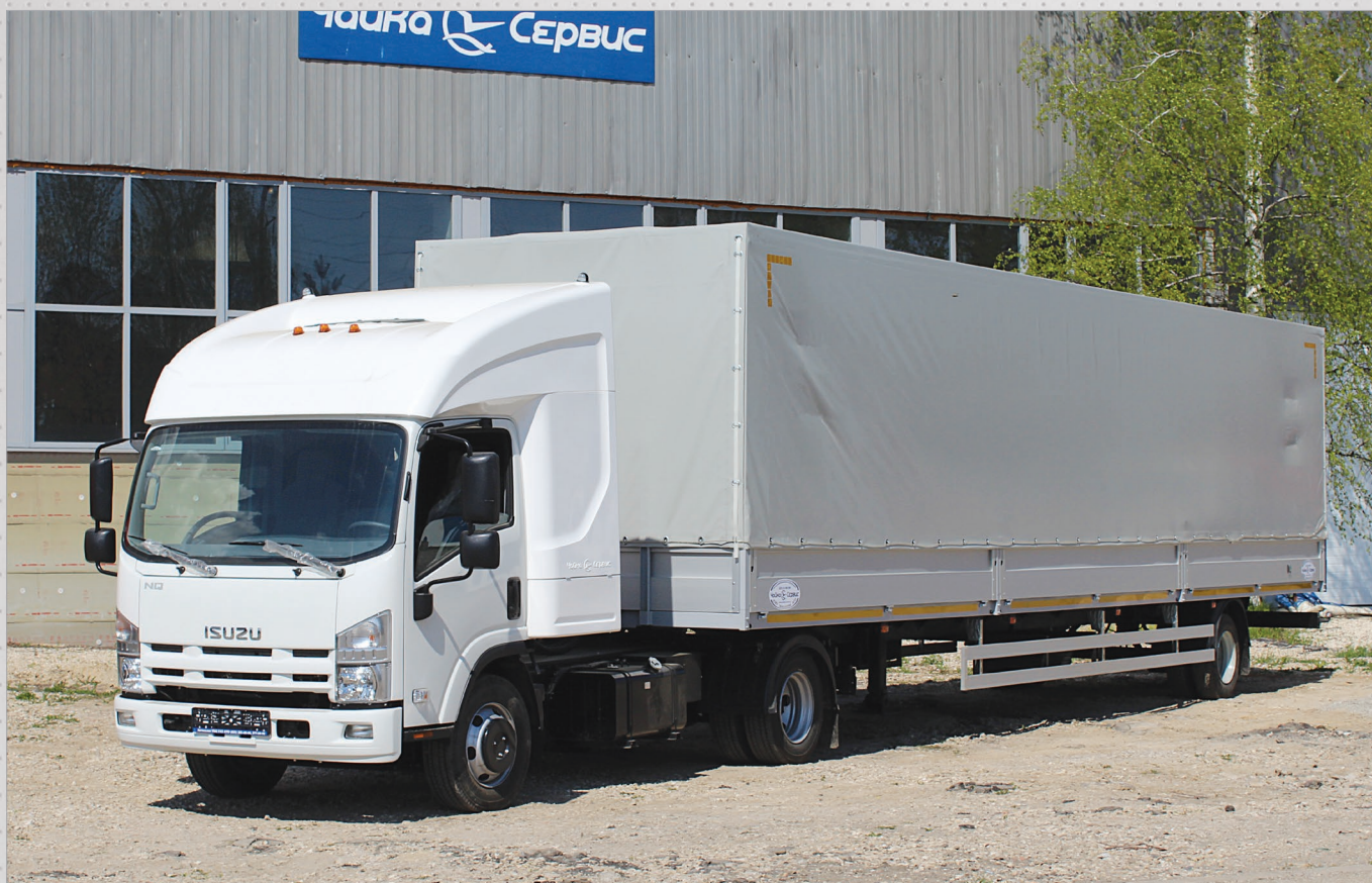
Полуприцеп с закабинным спальником на базе ISUZU NQR90LH. Длина полуприцепа 7,5 или 11 м, 12,2 м.
