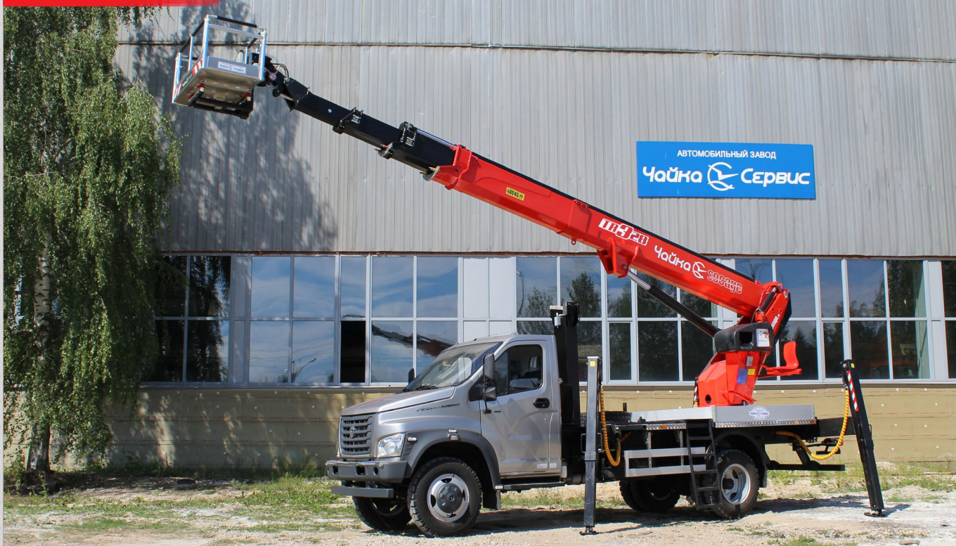
АГП телескопический Чайка-Socage TR328 с расположением за кабиной, высотой 28 м (г/п люльки - 400 кг, максимальный горизонтальный вылет 19.7 м) на шасси ГАЗон NEXT.
