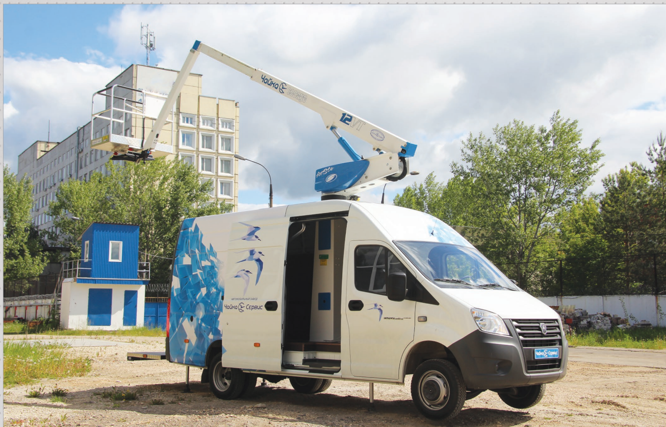
Автогидроподъемник телескопический Чайка-Socage 12VT высотой 12 м на базе цельнометаллической ГАЗель NEXT (ведется работа по АГП высотой 15 и 18 метров).
