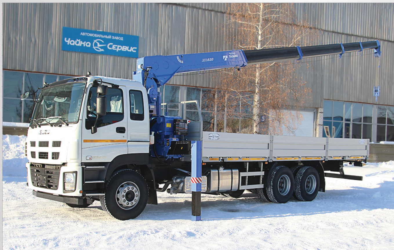
ISUZU CYZ52 с гидроманипулятором Чайка-Tadano TM-ZR825S и бортовой платформой Fuhmann. Макс. вылет – 15,67 м; г/п на минимальном радиусе (2,5 м) – 8000 кг; грузовой момент – 14,8 т*м. Масса перевозимого груза – 18155 кг.
