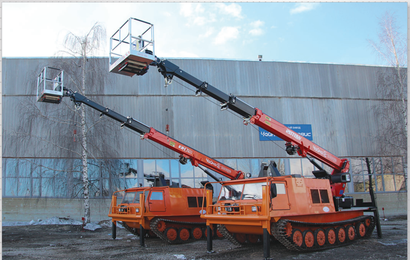
Автогидроподъёмник Чайка-Sosage T328W2 (высота подъёма – 28 м) с лебёдкой (г/п 1 т) на базе снегоболотохода СГТ-31 (возможна установка вышки высотой от 24 до 32 м).
