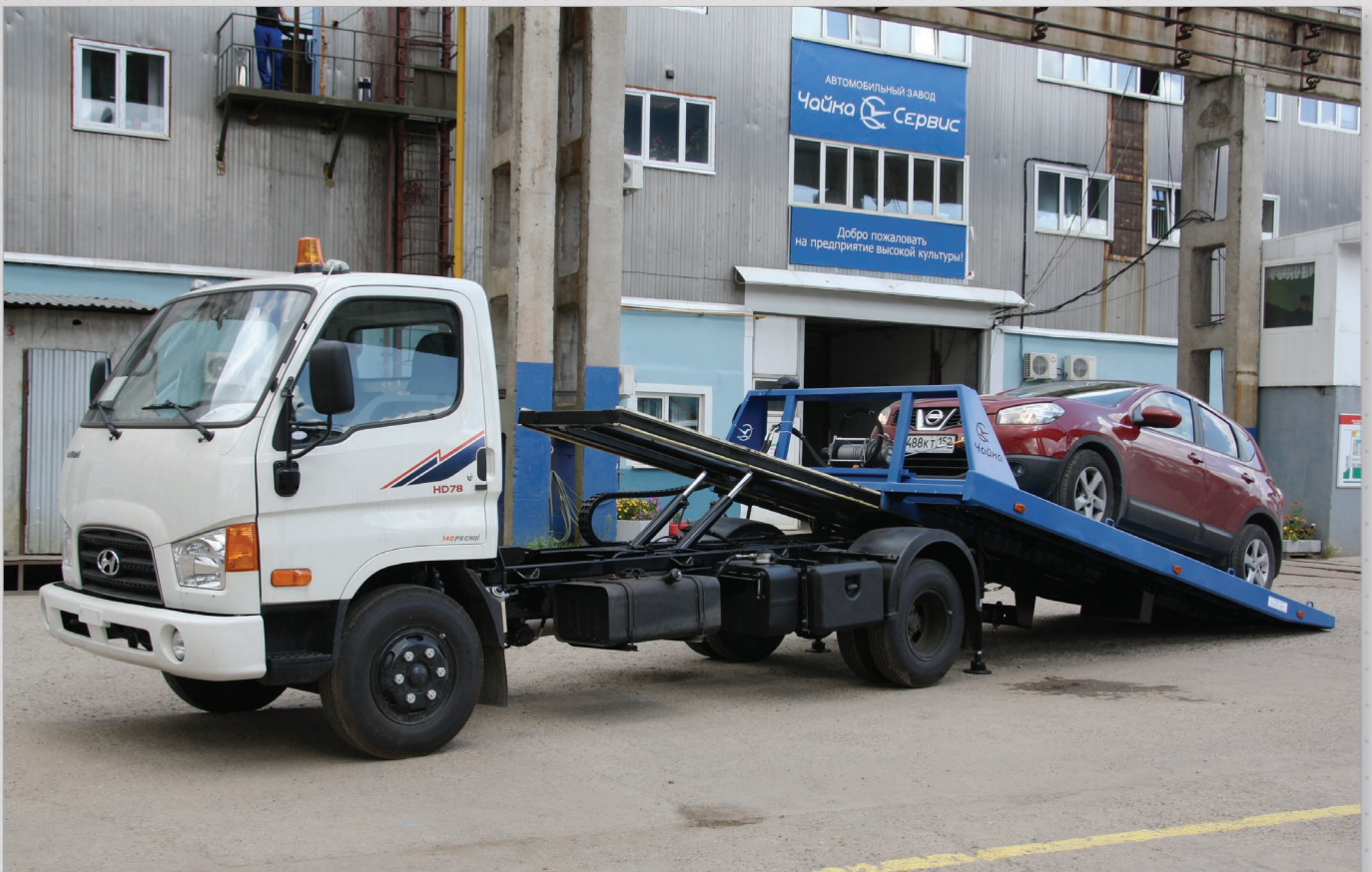
Эвакуатор со сдвижной платформой на базе Hyundai HD-78. Грузоподъемность платформы - 3500 кг.
