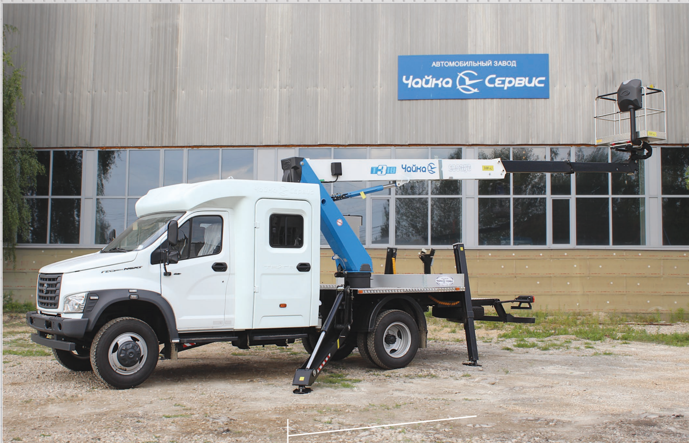
Автогидроподъемник телескопический Чайка-Socage T318 высотой 18 м на базе ГАЗон NEXT с двухрядной 4-дверной кабиной «Тайга» (возможна установка вышки высотой от 12 до 28 м).
