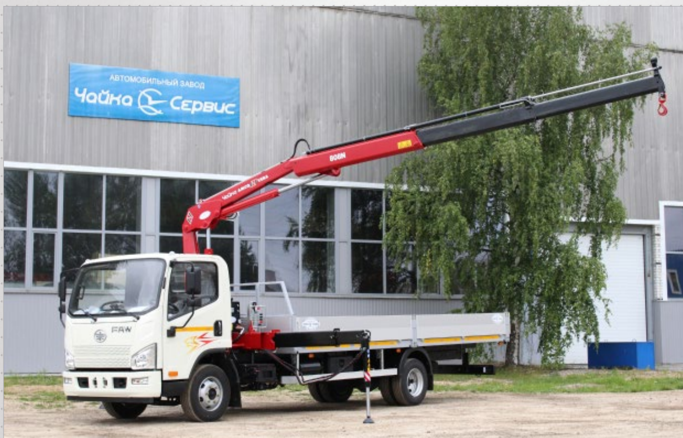
FAW TIGER V с КМУ Чайка-Амсо Veba 808N 2S. Макс. вылет – 7,15 м; г/п на макс. вылете – 1040 кг; грузовой момент – 7,9 т*м. Масса перевозимого груза – 2600 кг.
