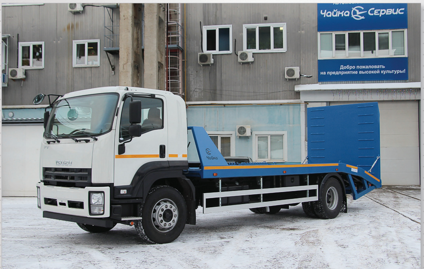
Эвакуатор с ломаной платформой и гидроаппаратурой на базе ISUZU FVR34. Конструктивно допустимая грузоподъемность – 8500 кг.
