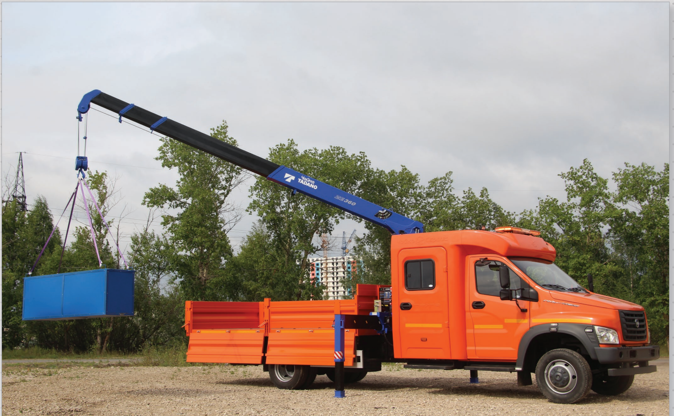
ГАЗон NEXT кабина «Тайга» с гидроманипулятором Чайка-Tadano TM-ZE364HS, стальные борта Fuhrmann. Макс. вылет – 9,8 м; г/п на минимальном радиусе (2,5 м) – 3000 кг; грузовой момент – 7,5 т*м. Масса перевозимого груза – 2490 кг.
