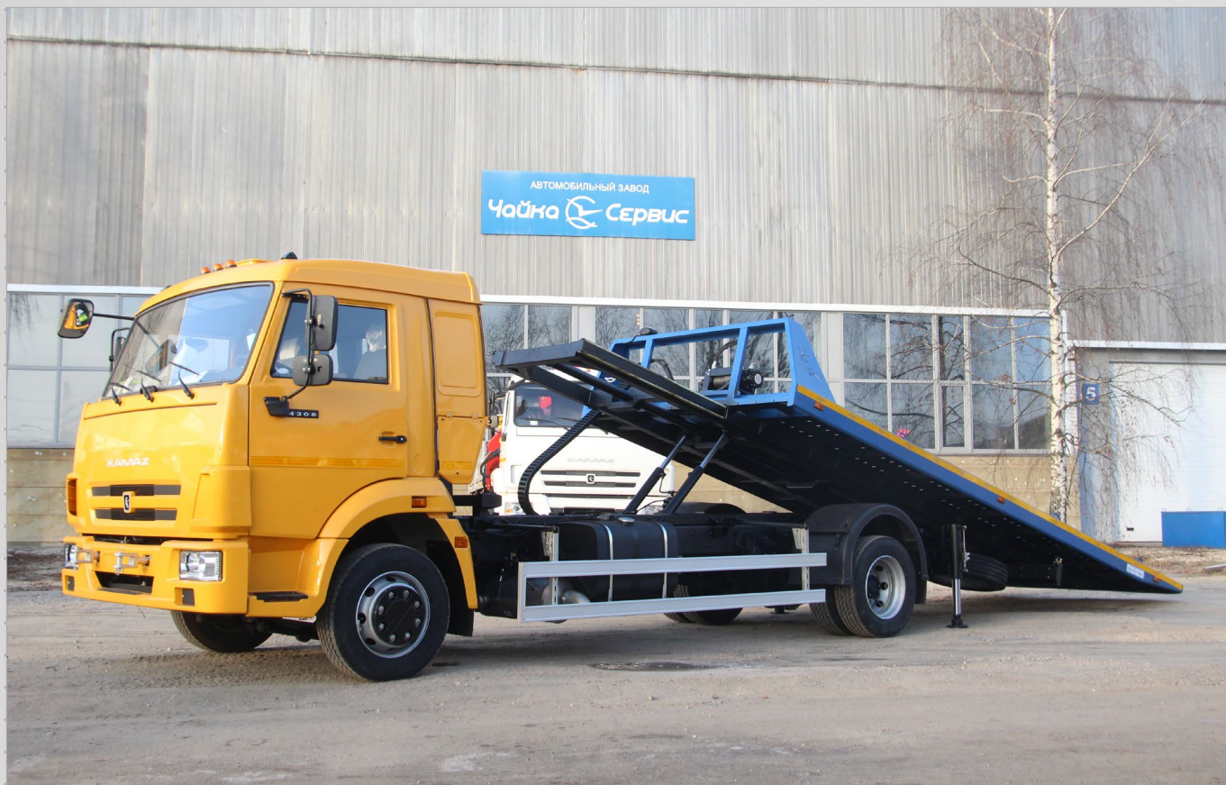
Эвакуатор со сдвижной платформой на базе КАМАЗ 4308. Грузоподъемность платформы - 3500 кг.
