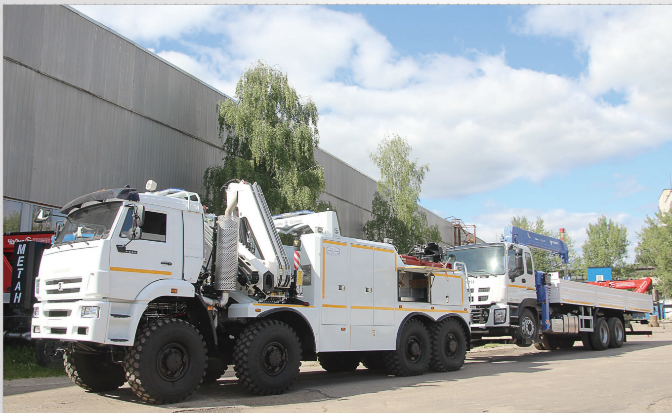
Эвакуатор с частичной погрузкой с КМУ на базе шасси КАМАЗ-6560 8x8. Грузоподъемность эвакуатора в стационарном положении с использованием задних опор (на полезном вылете 1525 мм) - 10 т, при буксировке - 6.4 т.
