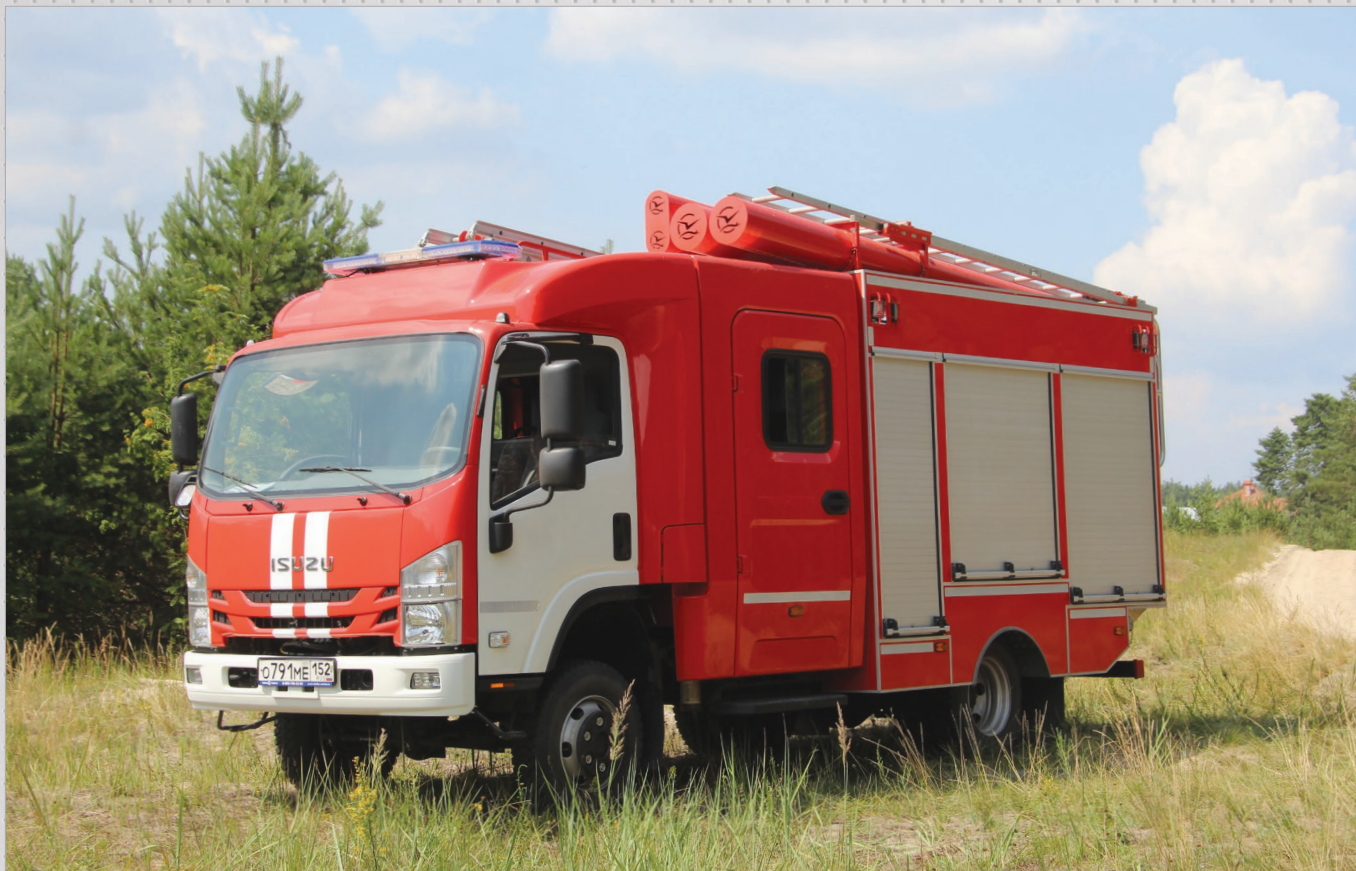
Автомобиль пожарно-спасательный АПС-1,0-40/4 на базе ISUZU NPR75 (4x4) с двухрядной 7-местной кабиной. Возможно увеличение объема бака до 2 м 3 .
