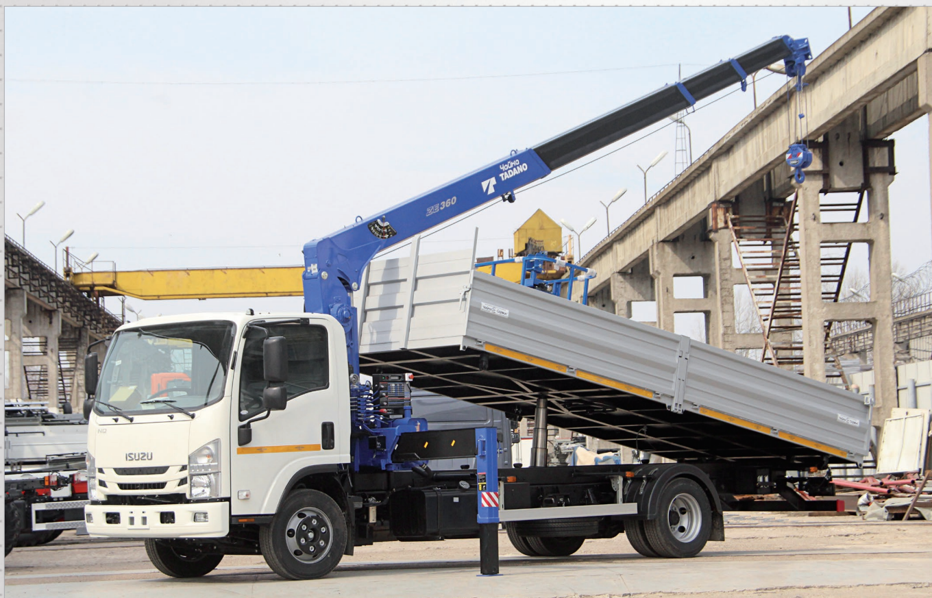
Самосвал с трехсторонней разгрузкой Isuzu с КМУ Tadano TM-ZE360HS. Грузоподъемность бортовой платформы - 3725 кг.
