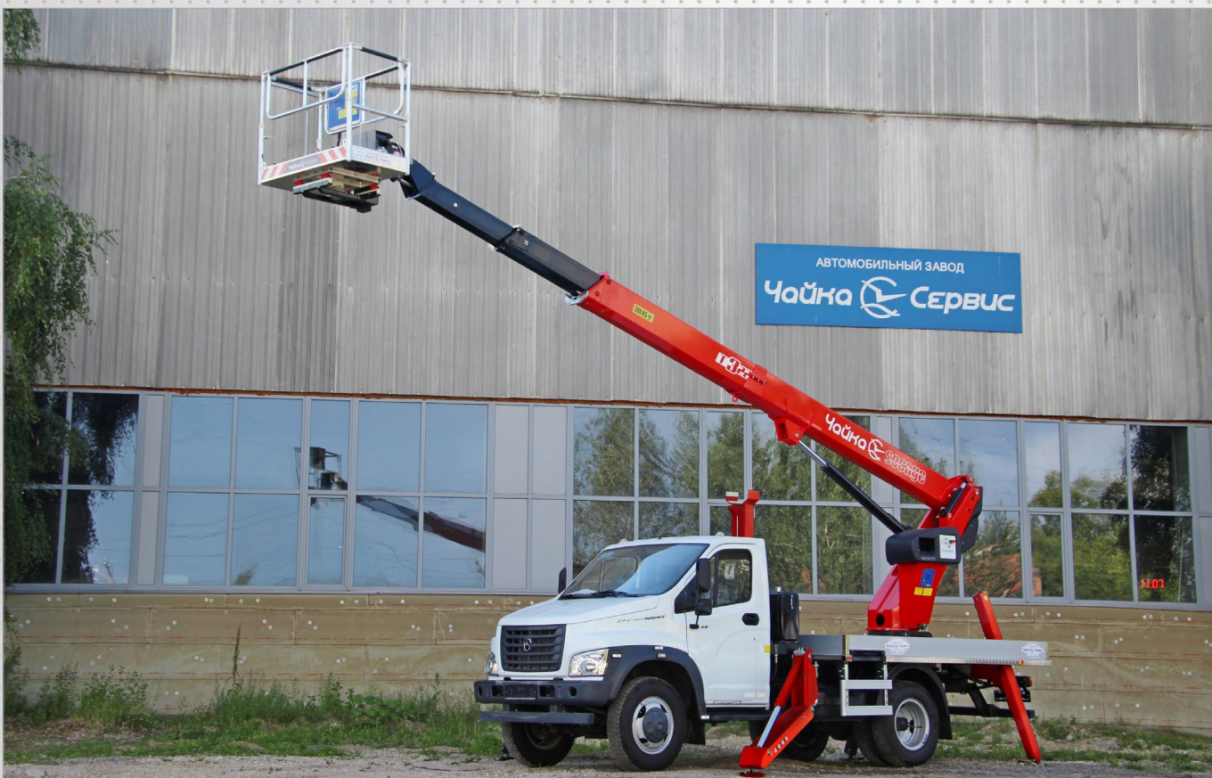
Аэродромный автогидроподъемник телескопический Чайка-Sosage T322 высотой 22 м на базе ГАЗон NEXT (возможна установка вышки высотой от 12 до 28 м).
