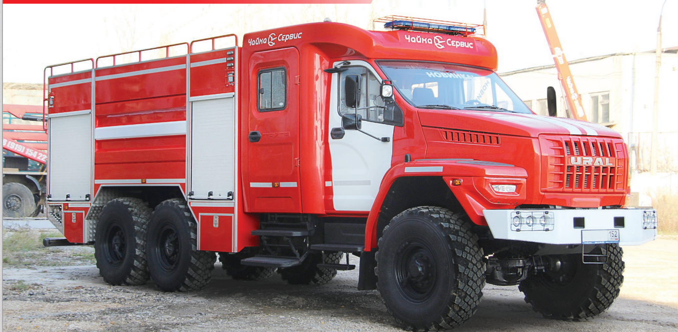
Пожарный автомобиль с двухрядной кабиной «Тайга» (7 мест) на базе УРАЛ NEXT АЦ-7,0-40/4 (4320). Запас огнетушащих средств: вода - 7 м 3 ; пенообразователь - 420 л. Возможно изготовление пожарно-спасательного автомобиля на базе УРАЛ NEXT АПС-6,0-40/4(4320).
