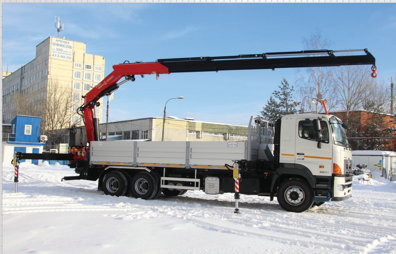
HINO 700 с гидроманипулятором Чайка-Fassi F335 на заднем свесе. Макс. вылет – 12,25 м; г/п на макс. вылете – 2275 кг; грузовой момент – 30,48 т*м. Конструктивно допустимая г/п автомобиля – 14950 кг.
