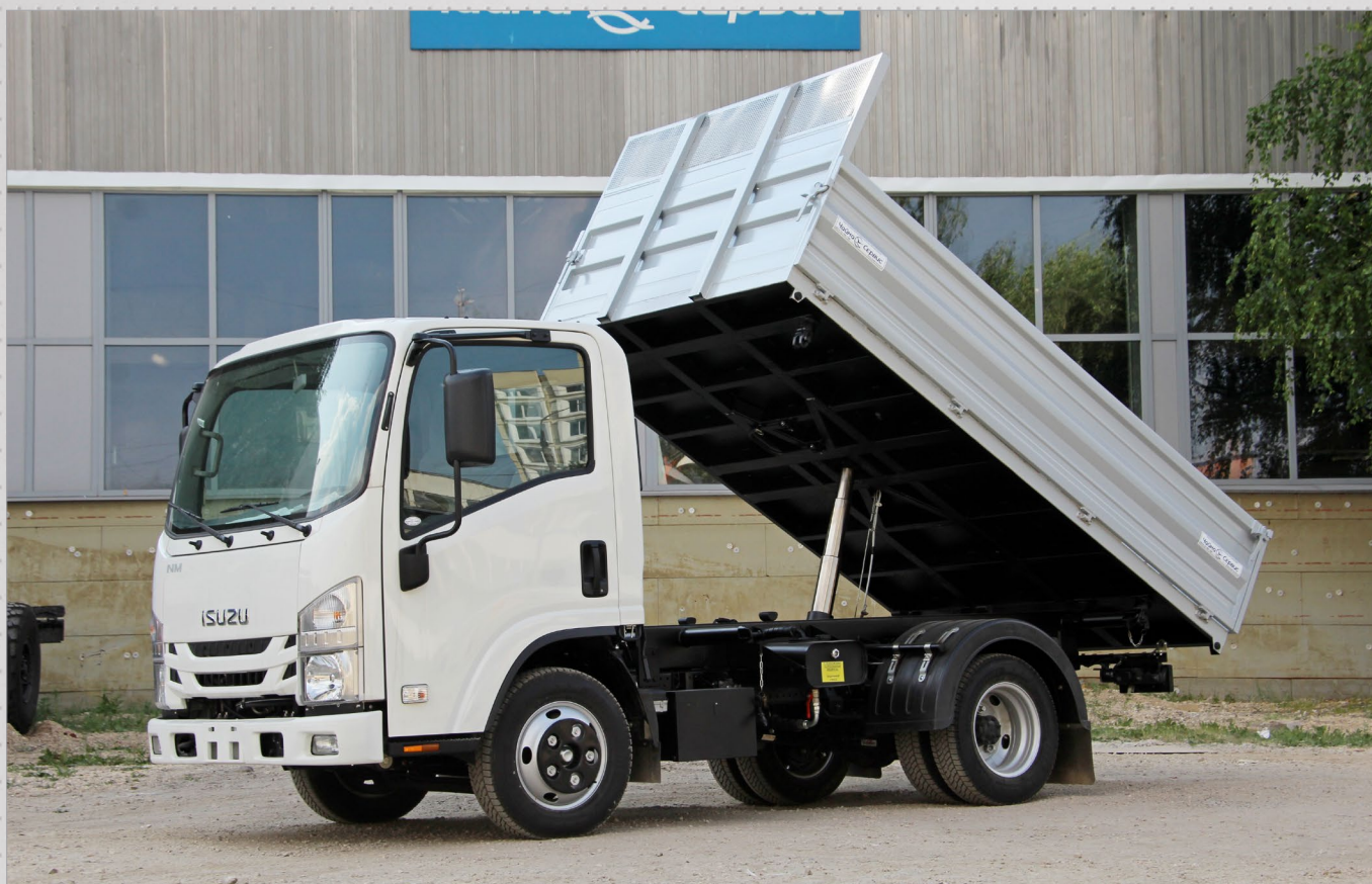
Самосвал с трехсторонней разгрузкой на базе Isuzu NMR, стальные борта Fuhrmann. Масса перевозимого груза - 3200 кг.
