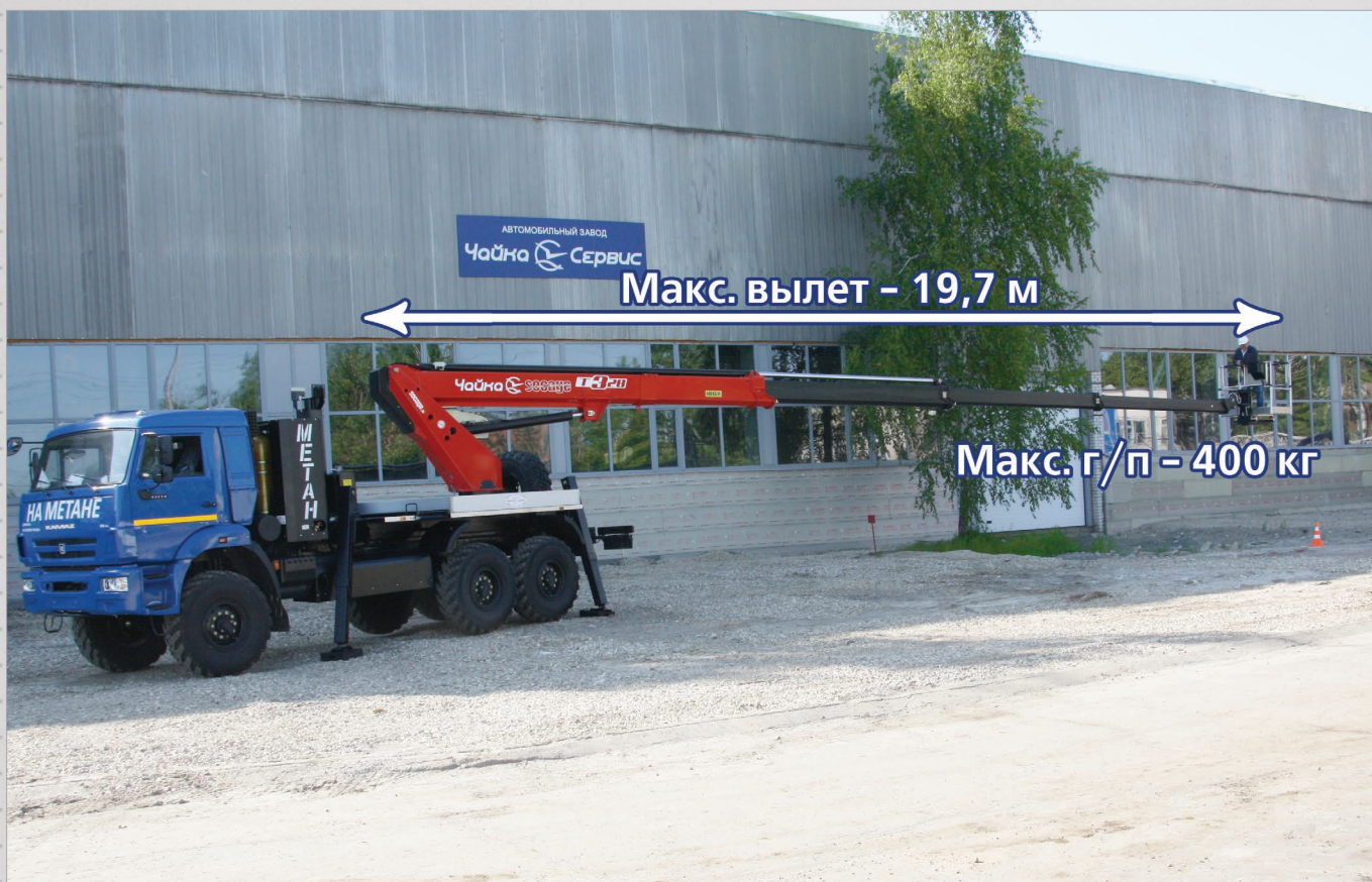
АГП комбинированный телескопический Чайка-Sosage T328 (высота подъёма – 28 м) на базе КАМАЗ-43114 с газомоторным оборудованием (ГБО) (возможна установка вышки высотой от 12 до 32 м).
