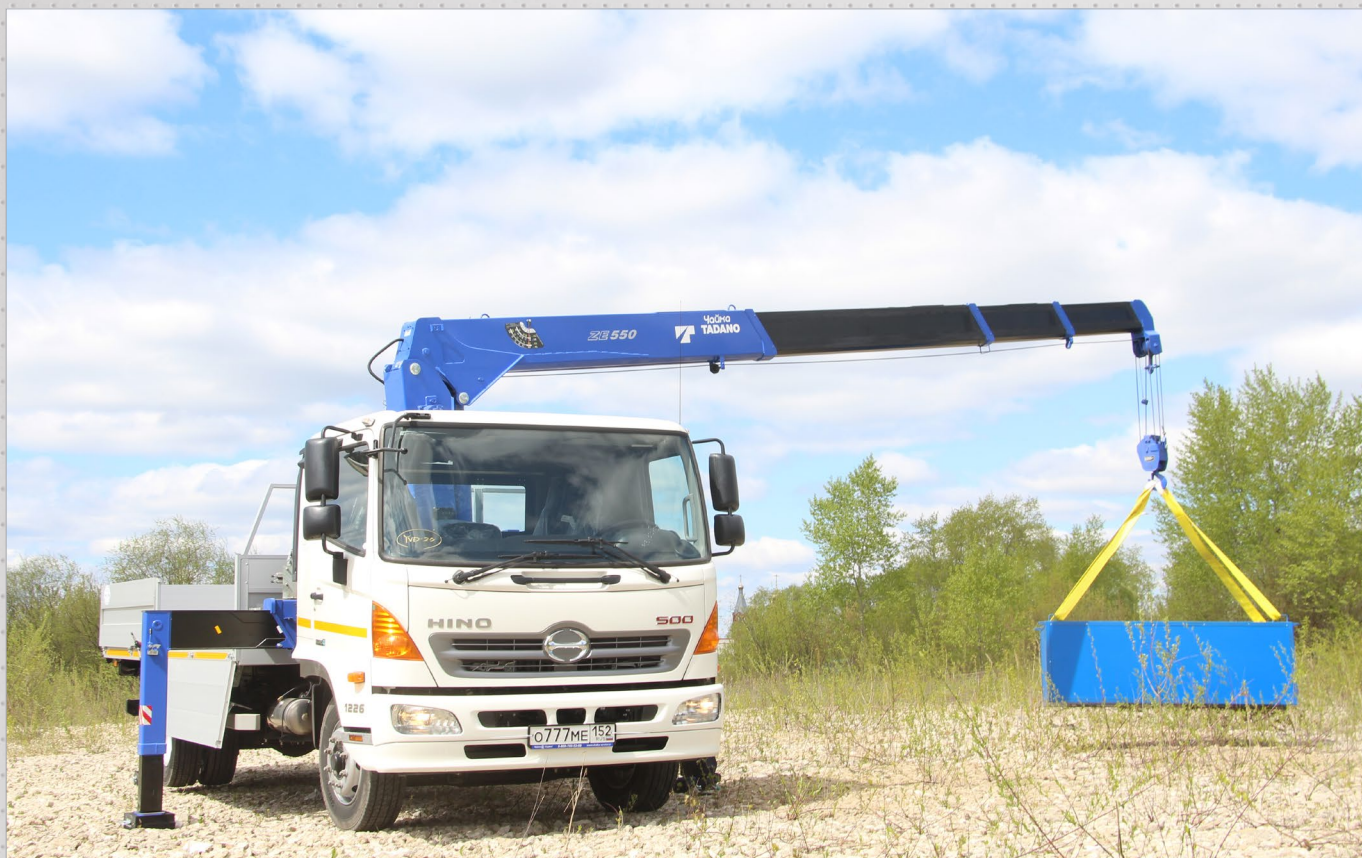
HI NO 500 с гидроманипулятором Чайка Tadano 554. Макс. вылет – 10,58 м; г/п на минимальном радиусе (2,5 м) – 5000 кг; грузовой момент – 12,5 т*м. Масса перевозимого груза – 4940 кг.
