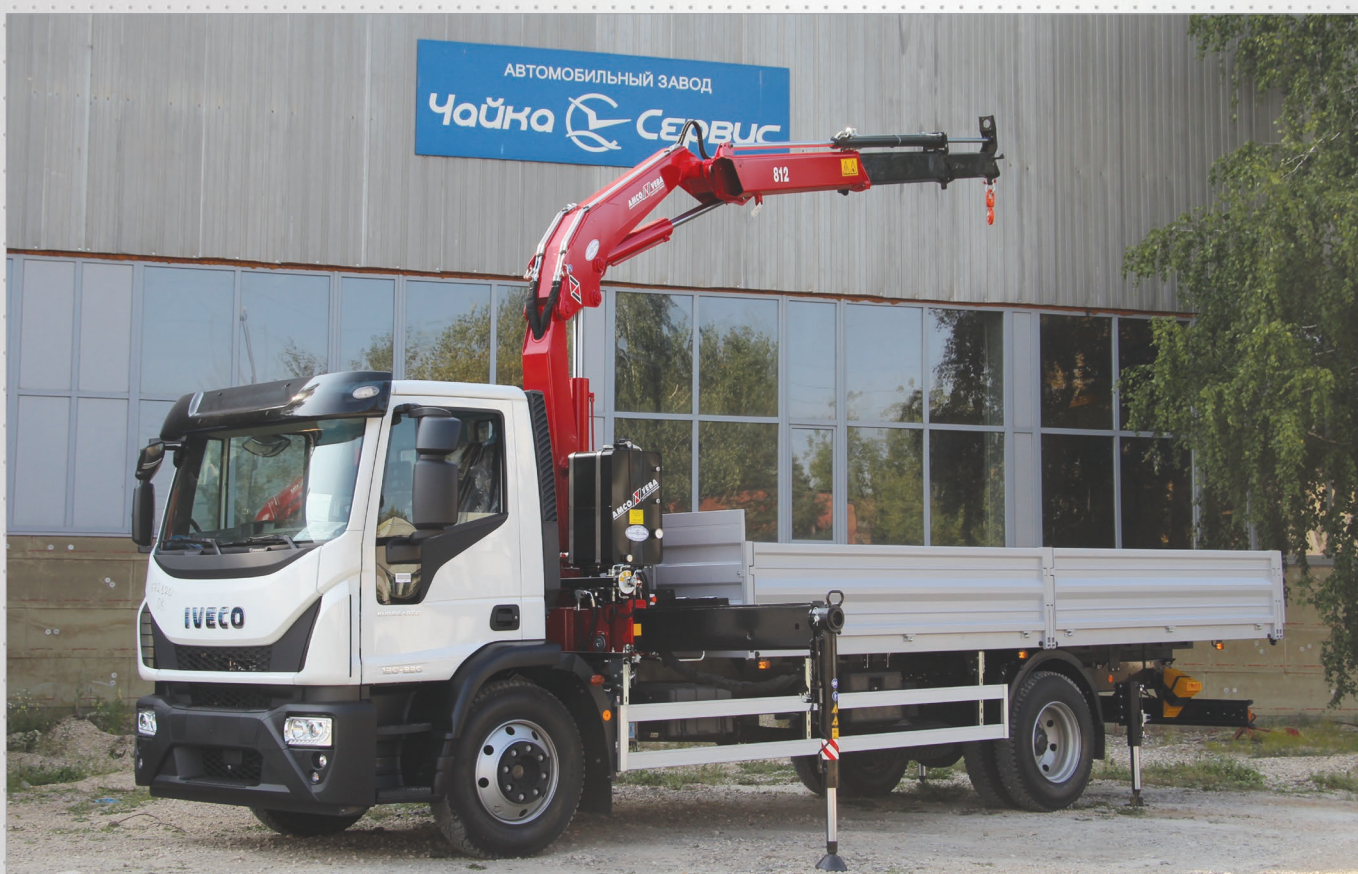
Iveco с гидроманипулятором Чайка-Атсо Veba 812 2S. Макс. вылет – 8,1 м; г/п на макс. вылете – 1360 кг; грузовой момент – 11,9 т*м. Масса перевозимого груза – 3790 кг.
