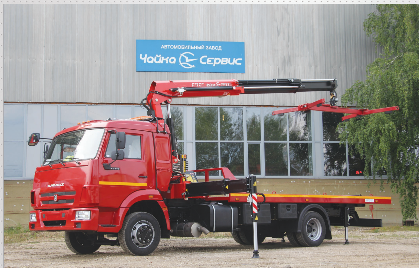
Эвакуатор с прямой платформой и гидроманипулятором Чайка-Fassi на базе КАМАЗ-4308. Грузоподъемность платформы - 4900 кг.
