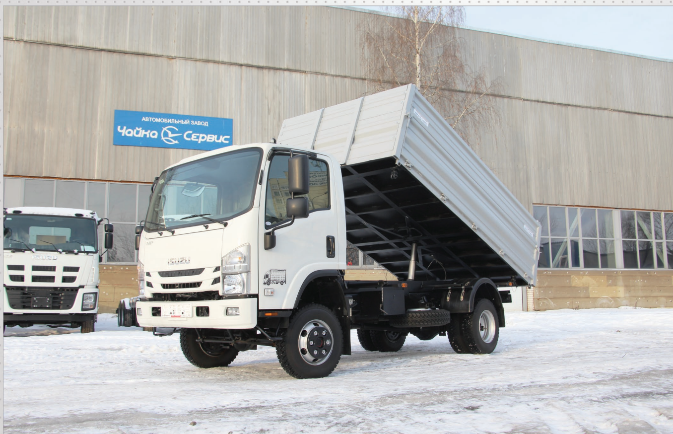
Самосвал с трехсторонней разгрузкой на базе Isuzu ELF 7.5 (NPS75) (4X4), стальные борта Fuhrmann. Масса перевозимого груза - 3200 кг.
