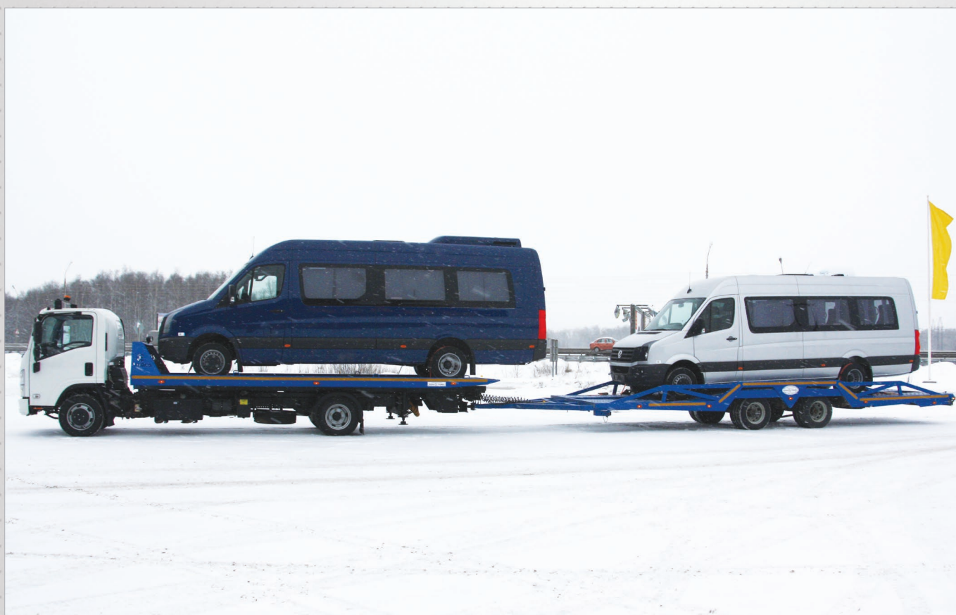
Автовоз в составе тягача-эвакуатора со сдвижной платформой на базе ISUZU NQR90 с прицепом, для перевозки трех автомобилей или двух микроавтобусов длиной до 7700 мм.
