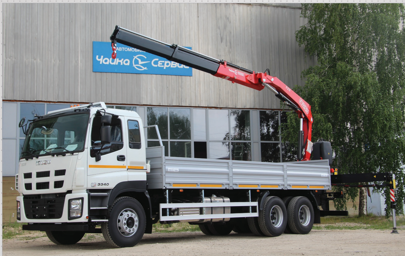
ISUZU GIGA с гидроманипулятором Чайка-Fassi F215 на заднем свесе. Макс. вылет – 8,05 м; г/п на макс. вылете – 2315 кг; грузовой момент – 18,86 т*м. Конструктивно допустимая г/п автомобиля – 18575 кг.
