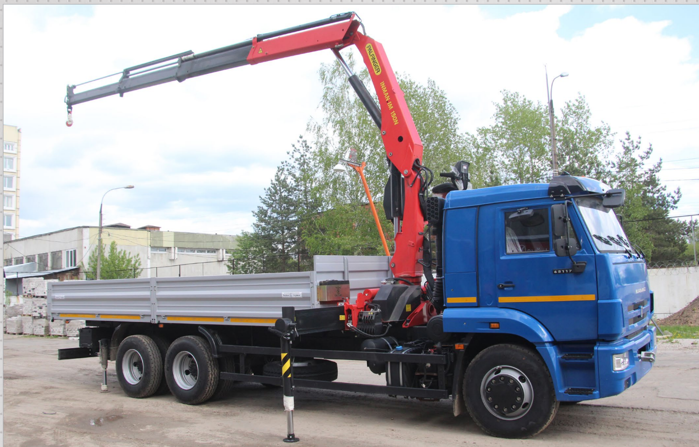
КАМАЗ-65117 с КМУ Palfinger Inman IM-150. Макс. вылет – 10,15 м; грузовой момент – 14,1 т*м. Грузоподъемность – 12310 кг.
