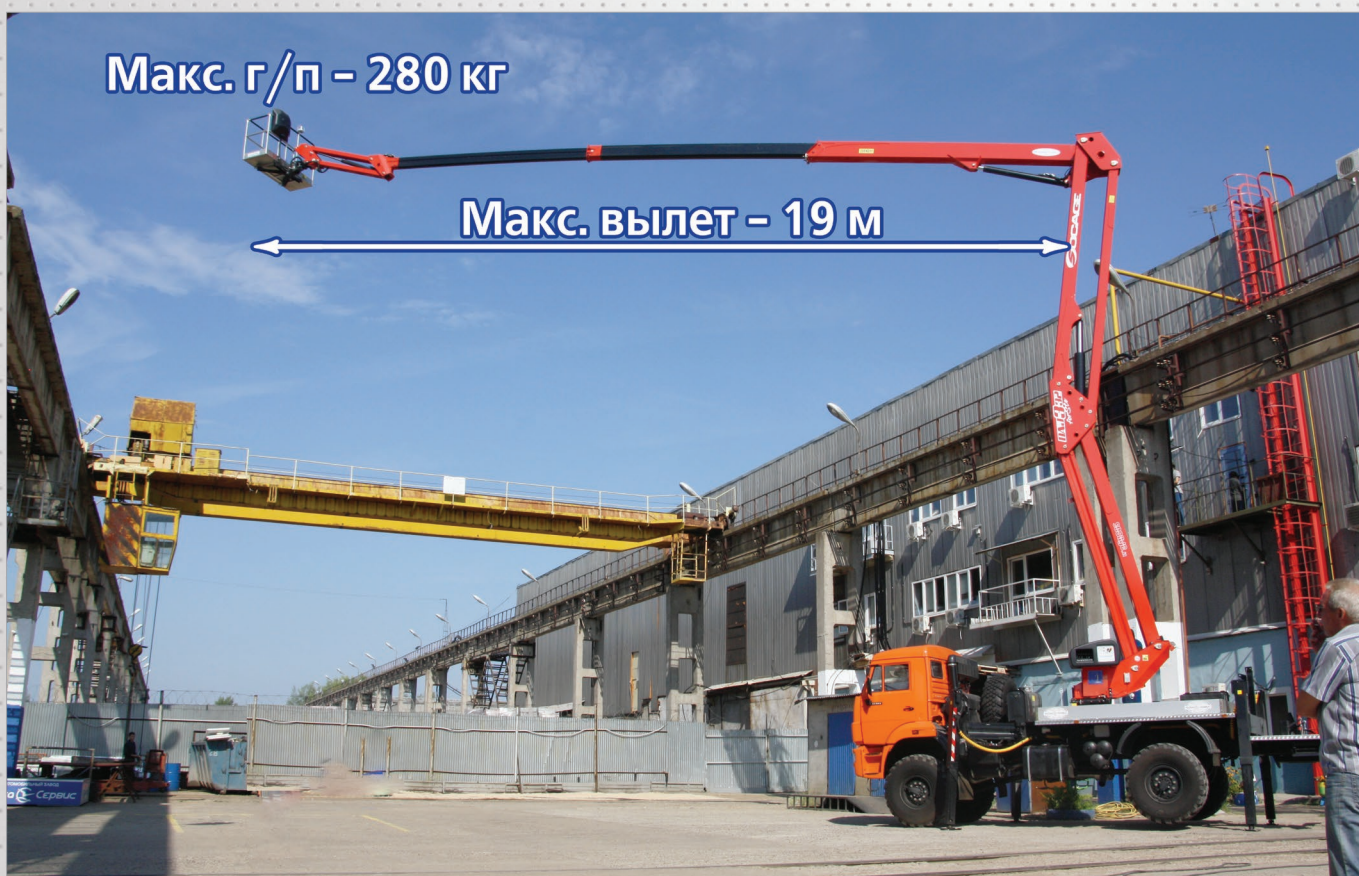
Автогидроподъемник комбинированный телескопический с гуськом Чайка-Sosage DAJ332 высотой 32 м на базе КАМАЗ-43502 (возможна установка вышки высотой от 12 до 32 м).
