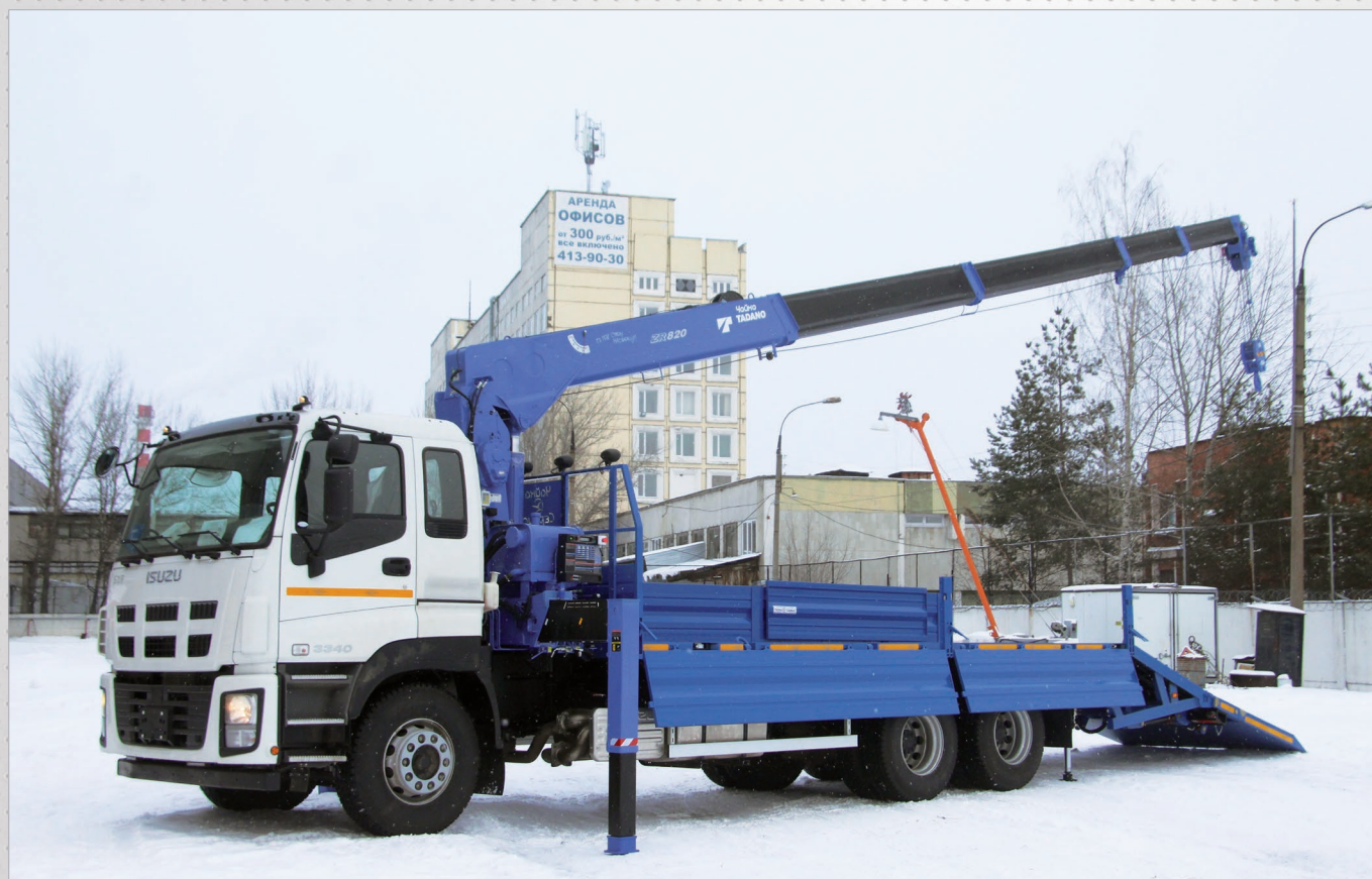
Эвакуатор с ломанной платформой и КМУ Tadano на базе Isuzu CYZ. Стальные борта Fuhrmann. Грузоподъемность платформы - 14650 кг.
