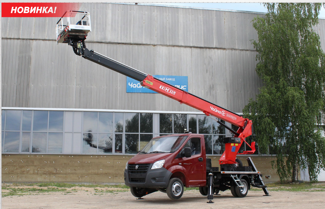
Автогидроподъемник комбинированный телескопический Чайка-Socage TR315 высотой 15 м на базе Газель Next (ГАЗ - А21R23).
