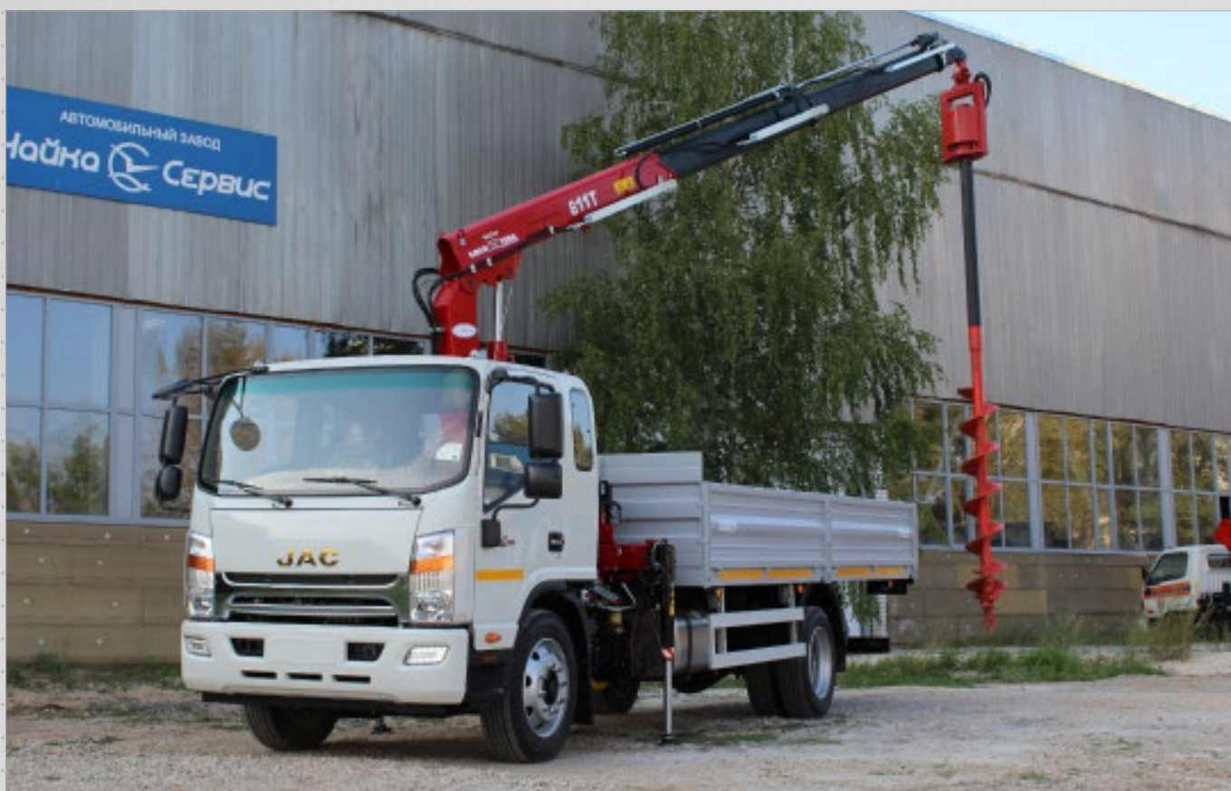
JAC N120 с гидроманипулятором Чайка-Атсо Veba 811 2s с буром. Макс. вылет – 6 м; г/п на макс. вылете – 1670 кг; грузовой момент – 10,3 т*м. Масса перевозимого груза – 5000 кг.
