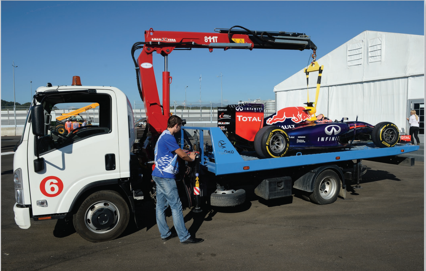
Эвакуатор со сдвижной платформой и гидроманипулятором Чайка-Amco Veba 811T на базе ISUZU. Грузоподъёмность платформы - 2175 кг.
