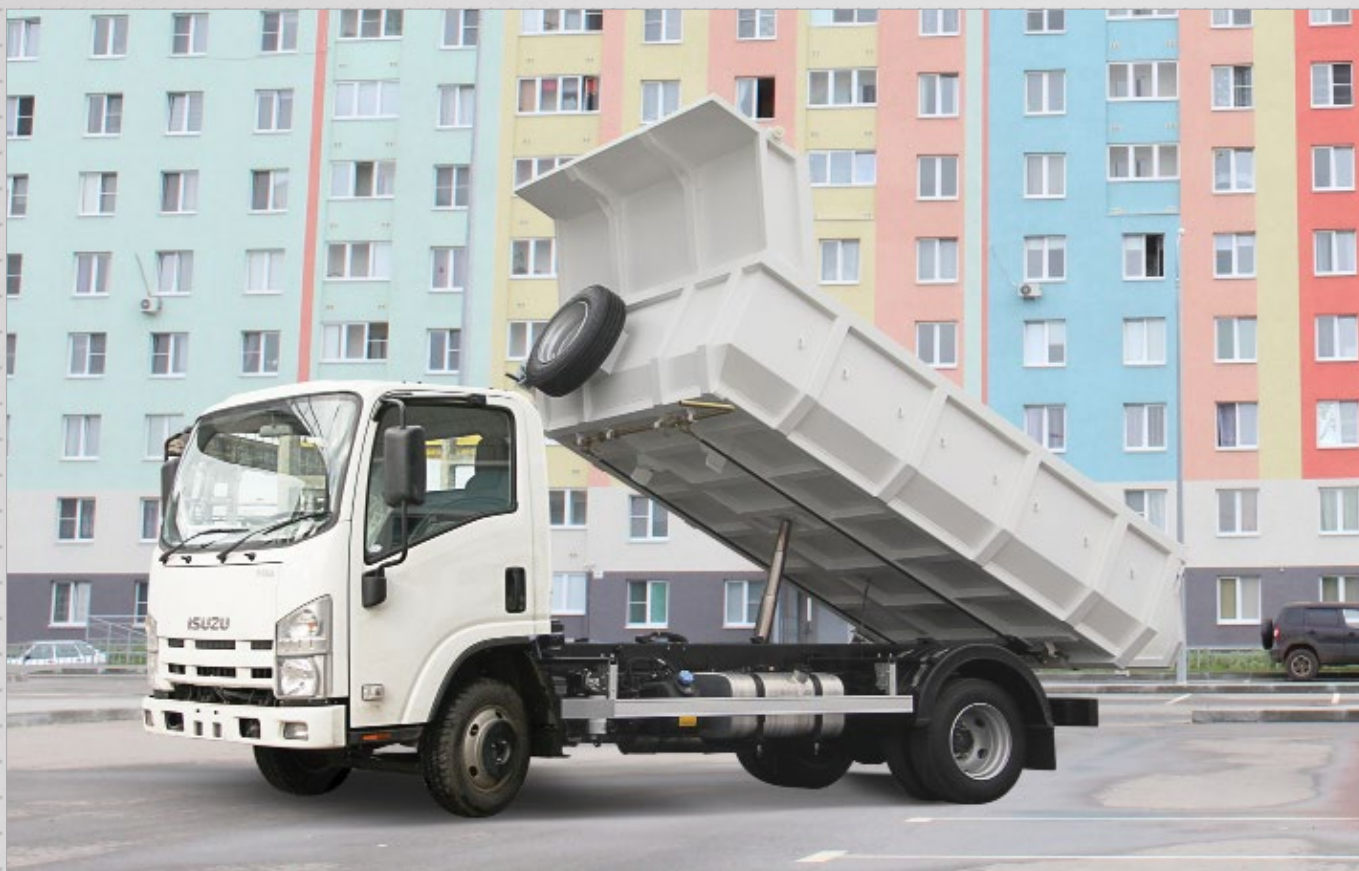
Самосвал «совок» на базе ISUZU. Масса перевозимого груза - 3500 кг. Объем платформы - 6м 3
