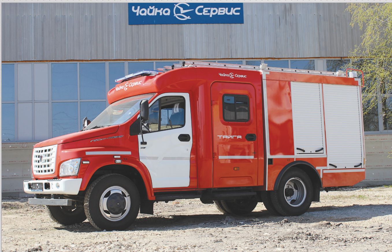
Пожарный автомобиль с двухрядной 4-дверной кабиной «Тайга» (7 мест) на базе ГАЗон NEXT АЦ-1,0-40/4 (С41R13). Возможно увеличение объема бака до 2 или 3 м 3 .
