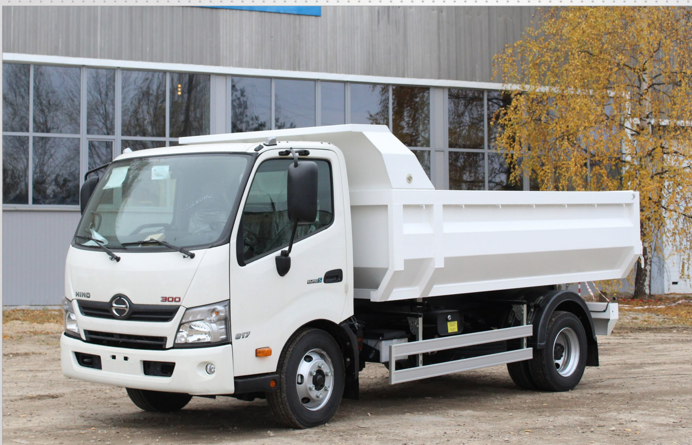
Самосвал «совок» на базе Hino-300. Масса перевозимого груза - 3500 кг. Объем платформы - 6м 3
