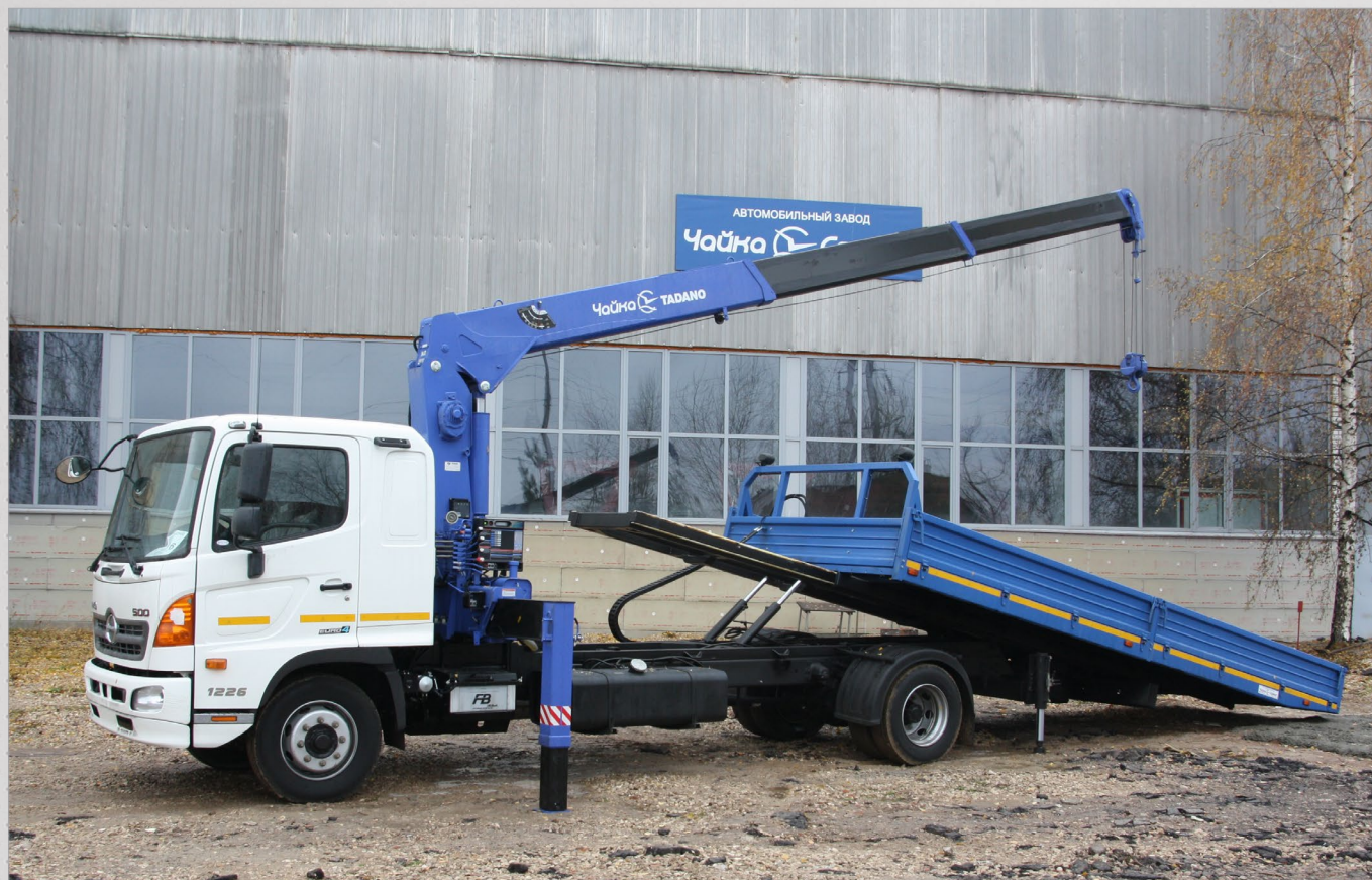
Эвакуатор со сдвижной платформой и КМУ Tadano на базе HINO 500. Грузоподъемность платформы - 6000 кг.
