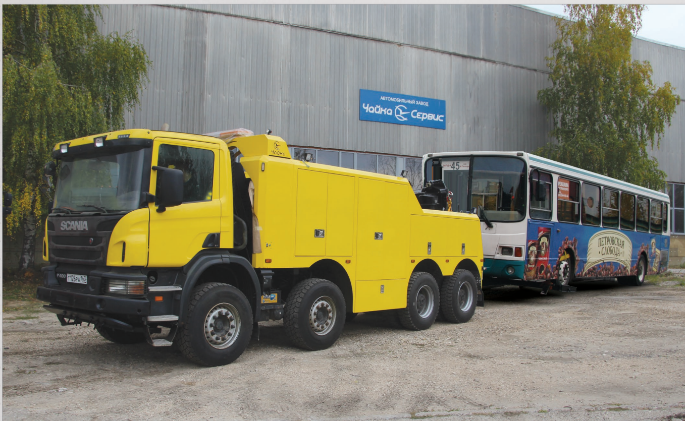
Эвакуатор с частичной погрузкой на базе Scania P400. Конструктивно допустимая грузоподъемность надстройки в транспортном положении на полезном вылете 1525 мм - 12 т, в рабочем положении - 9 т.
