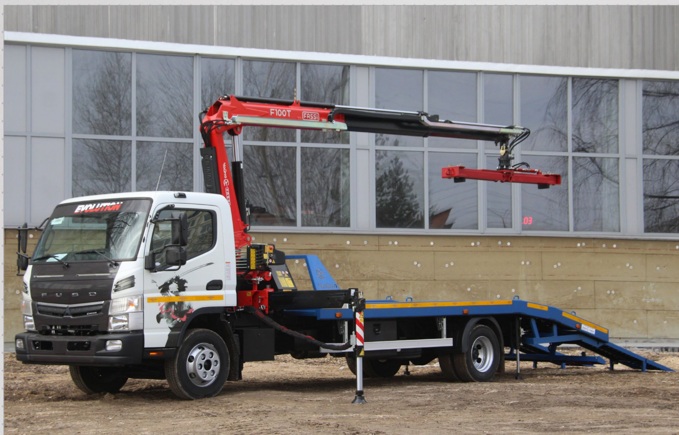
Эвакуатор с ломаной платформой и гидроманипулятором Чайка-Fassi F-100 на базе FUSO. Грузоподъемность платформы - 3375 кг.
